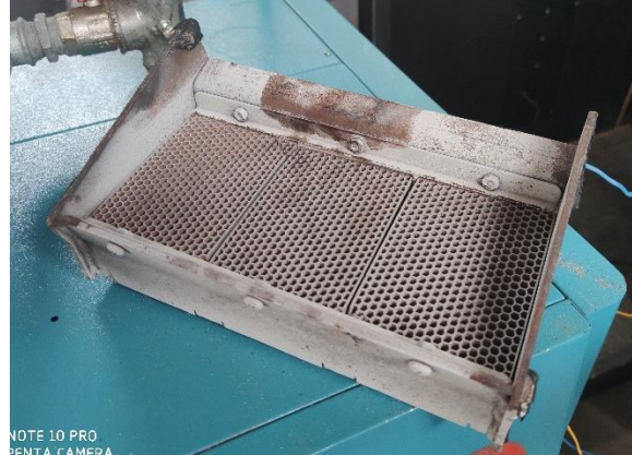
Slika 24. Saćasti umetak za naknadno izgaranje
