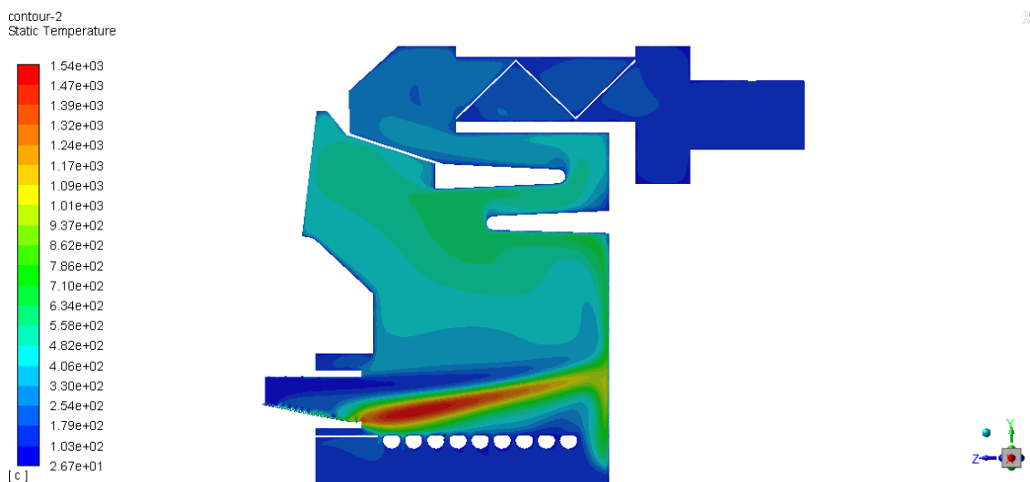
a) temperaturna polja u centralnom presjeku
