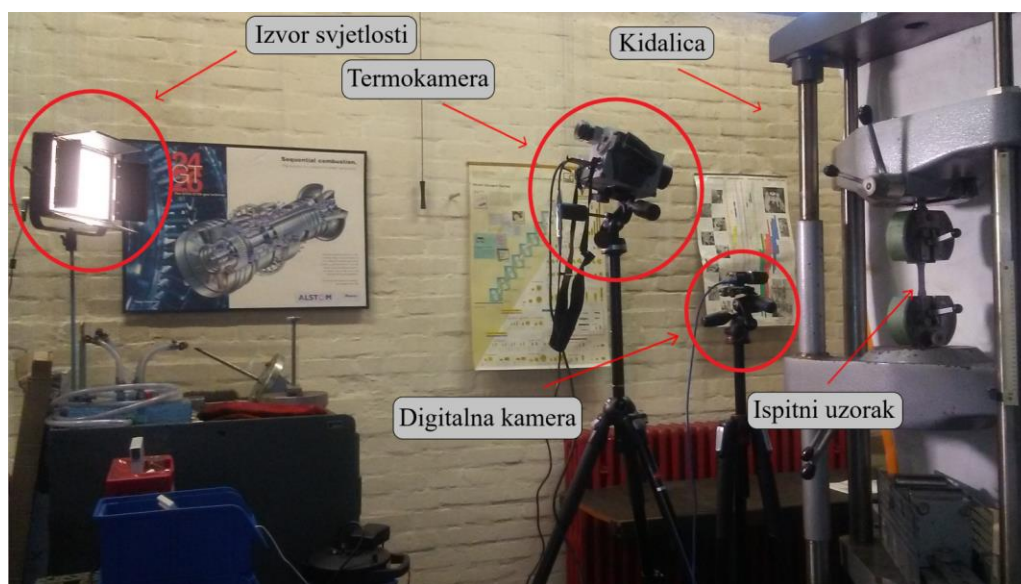
Slika 6-8. Raspored korištene opreme tijekom ispitivanja.
