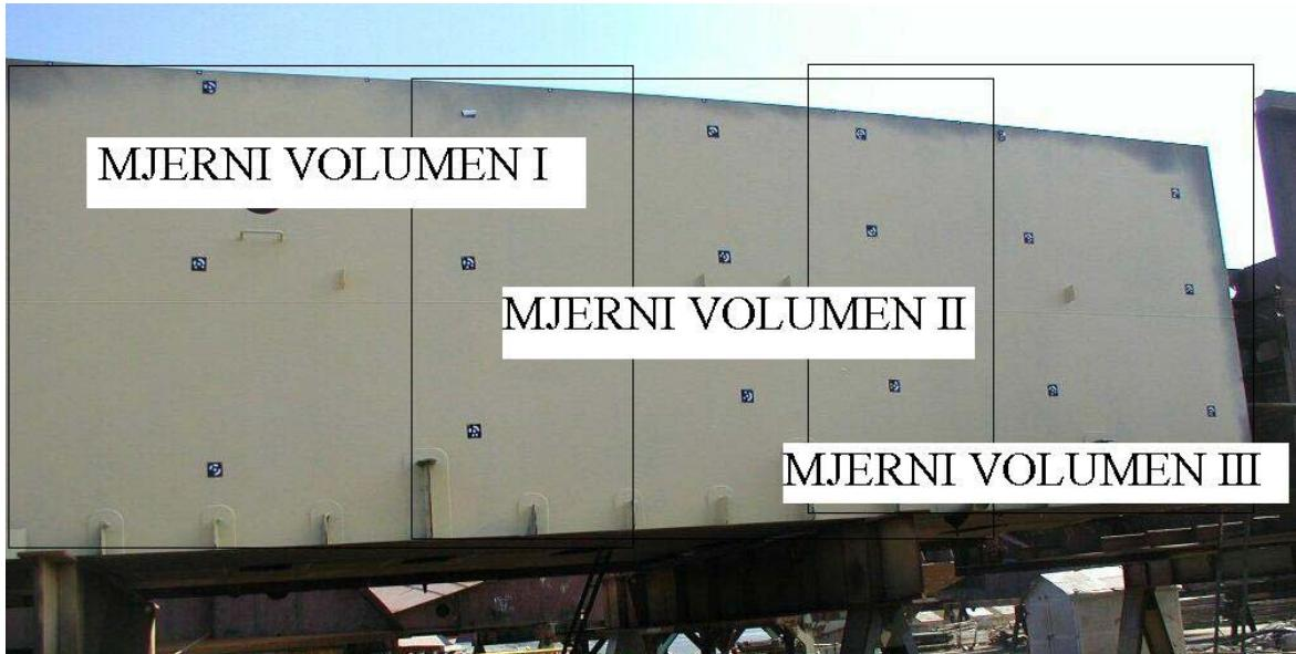
Slika 45: Postupak snimanja volumenskih objekata s preklapanjem
