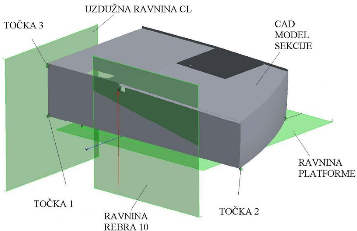
Slika 119: Preklapanje CAD modela sekciјe i svjetlog otvora
