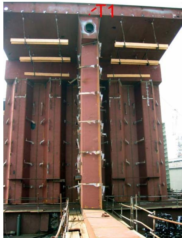
Slika 31: Postavljanje mjerne točke u simetralu sekcije
