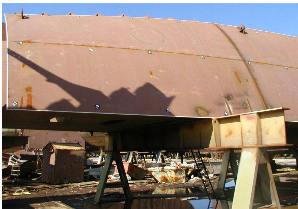
Slika 76: Sekcija na okvirnim potkladama
