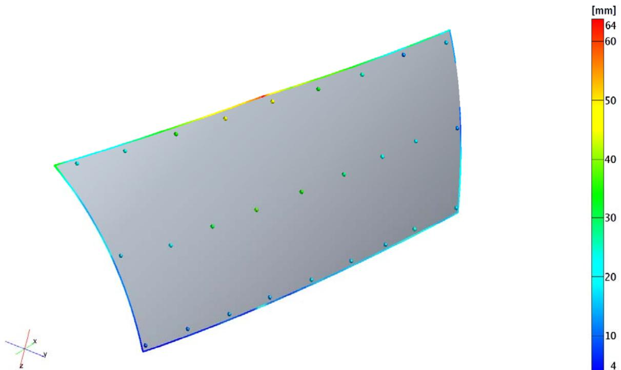
Slika 58: Preklapanje rezultata mjerena vanjske oplate sa CAD modelom
