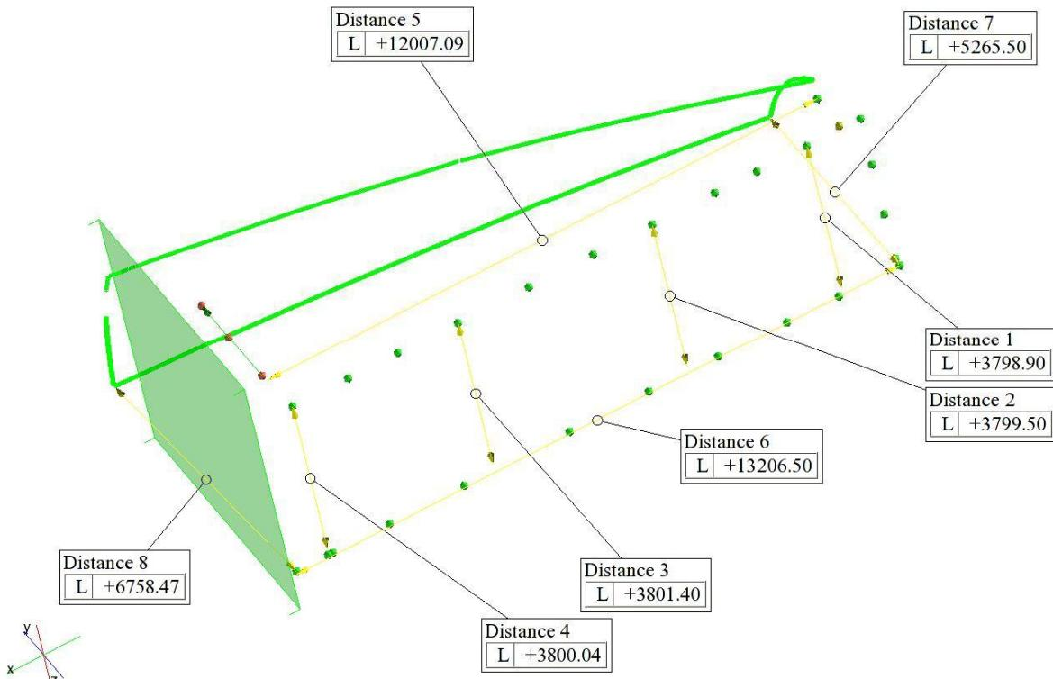
Slika 90: Mjerenje udaljenosti zadanih mjernim skicama dimenzijske kontrole
