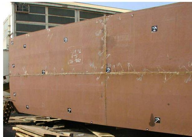
Slika 99: Mjerne točke na vanjskoj oplati na boku broda
