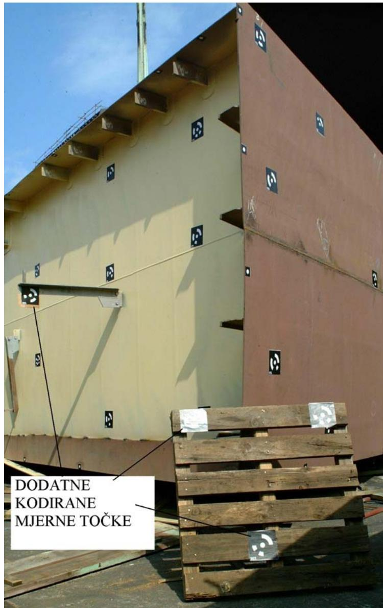
Slika 46: Postavljanje dodatnih mjernih točaka
