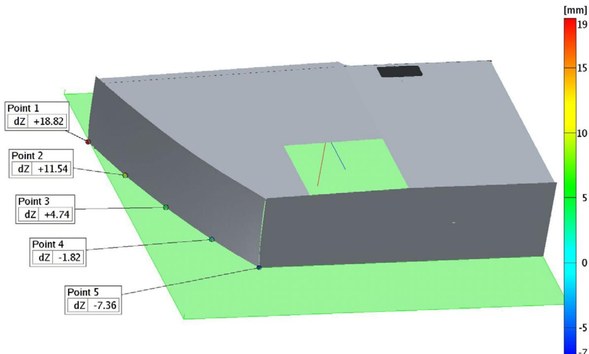
Slika 123: Analiza odstupanja mjernih točaka CAD modela sekcije na šavu vanjske oplate
