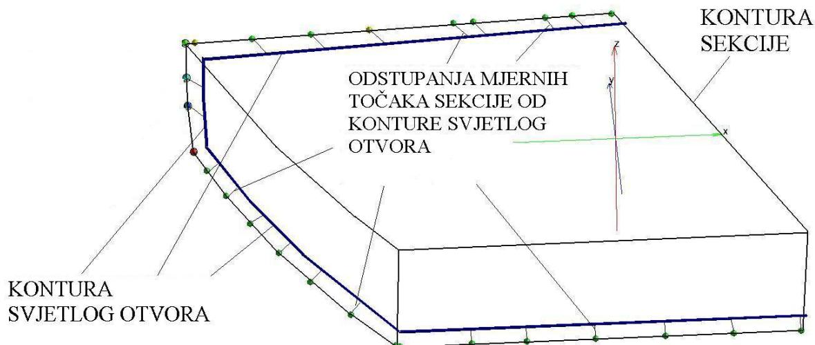
Slika 96: Mjerenje odstupanja mjernih točaka sekciije od konture svjetlog otvora
