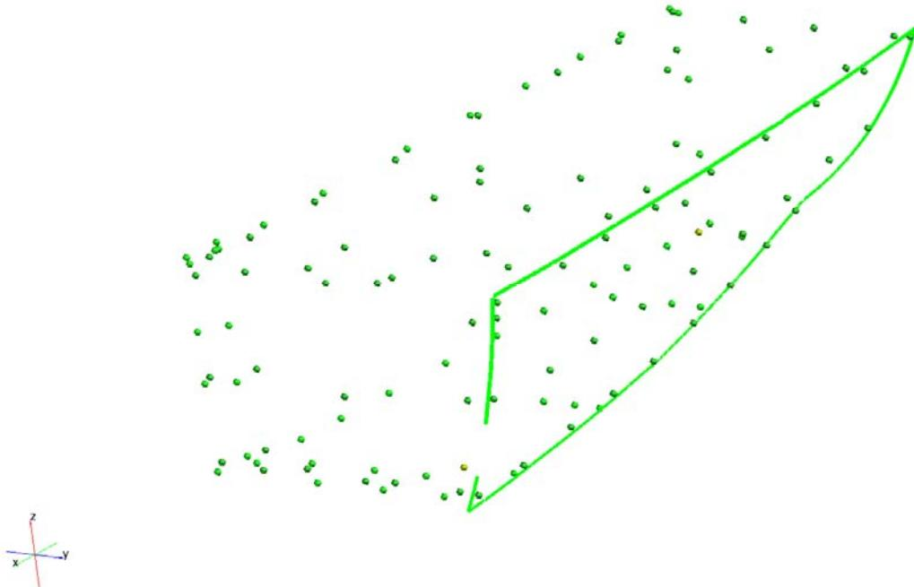
Slika 80: Oblak mjernih točaka dijelova sekcije i rub vanjske oplate
