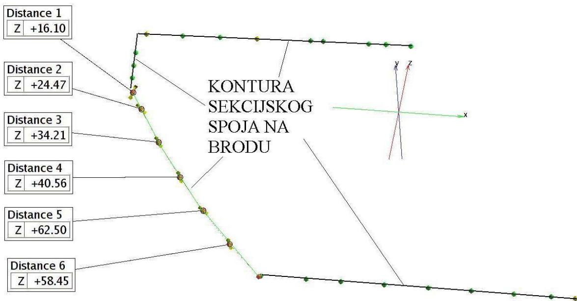
Slika 116: Odstupanja mjernih točaka sekcije na šavu vanjske oplate
