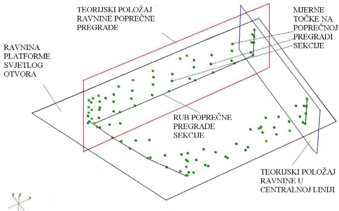
Slika 108: Elementi preklopa rezultata mjerena sekcijske i svjetlog otvora
