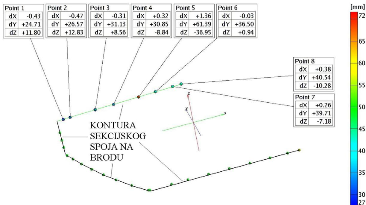
Slika 114: Odstupanja mjernih točaka sekciije na stiku palube
