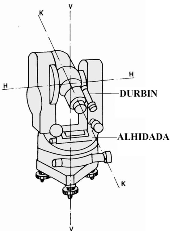
Slika 3: Osnovni dijelovi i glavni pravci mjernog uređaja
