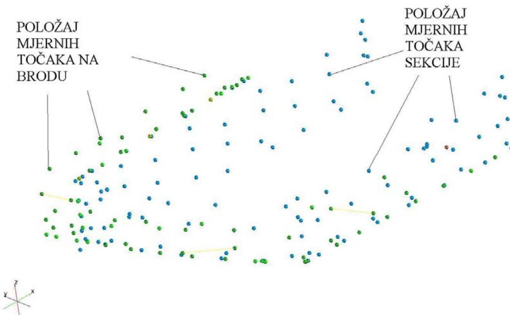
Slika 109: Preklapanje rezultata mjerena sekcijske i svjetlog otvora
