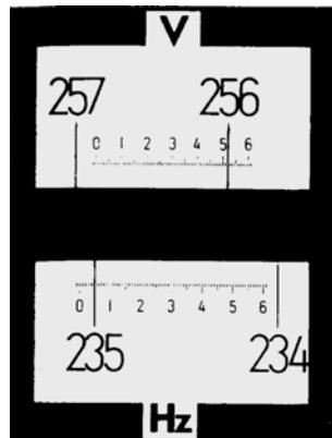
Slika 4: Mjerni dio uređaja i skala za očitanje optičkog teodolita
