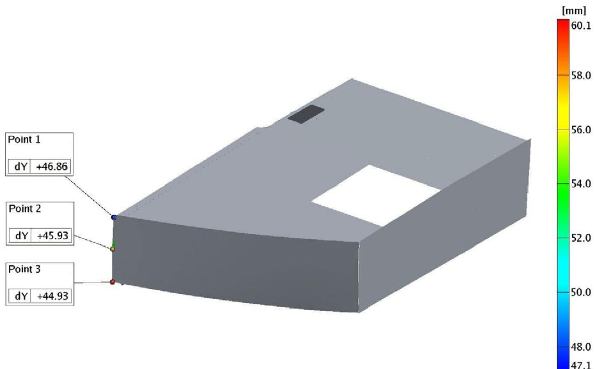
Slika 122: Analiza odstupanja mjernih točaka CAD modela sekcije na stiku vanjske oplate
