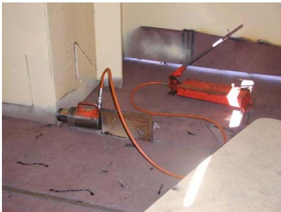
Slika 24: Hidraulička pumpa za pozicioniranje sekcije
