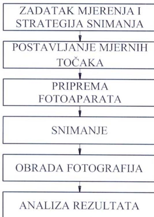
Slika 74: Dijagram toka aktivnosti mjerenja fotogrametrijskim sustavom
