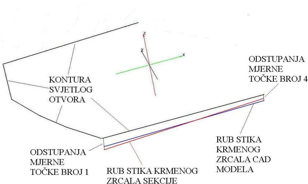
Slika 124: Odstupanja krmenog zrcala sekcijske i CAD modela od konture svjetlog otvora
