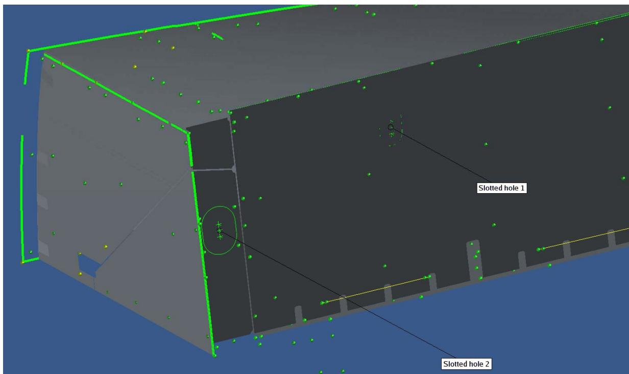
Slika 68: Preklapanje rezultata mjerenja i CAD modela sekcije
