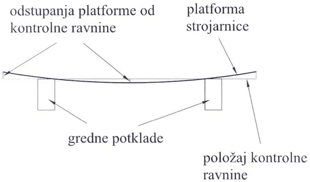
Slika 84: Uzdužni presjek platforme na grednim potkladama
