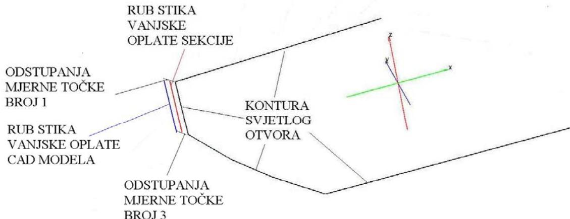
Slika 126: Odstupanja stika vanjske oplate sekcije i CAD modela od konture svjetlog otvora
