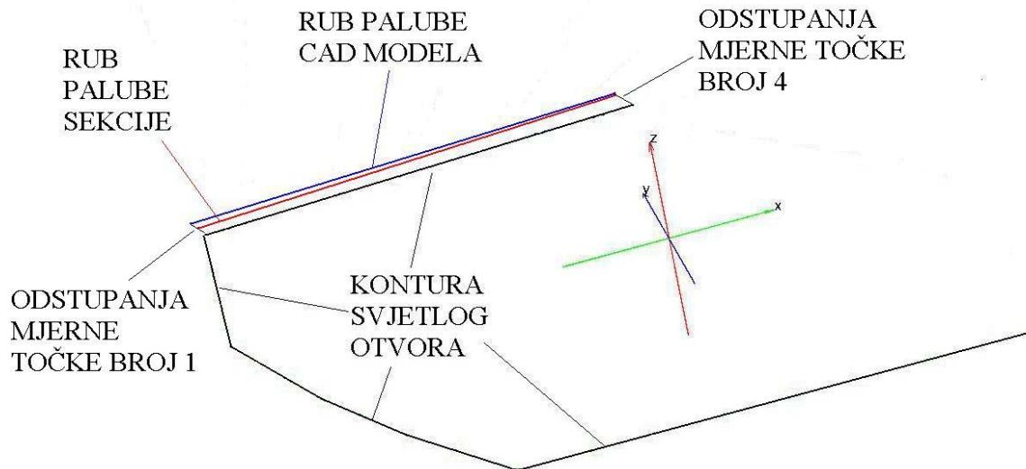
Slika 125: Odstupanja palube sekcijske i CAD modela od konture svjetlog otvora
