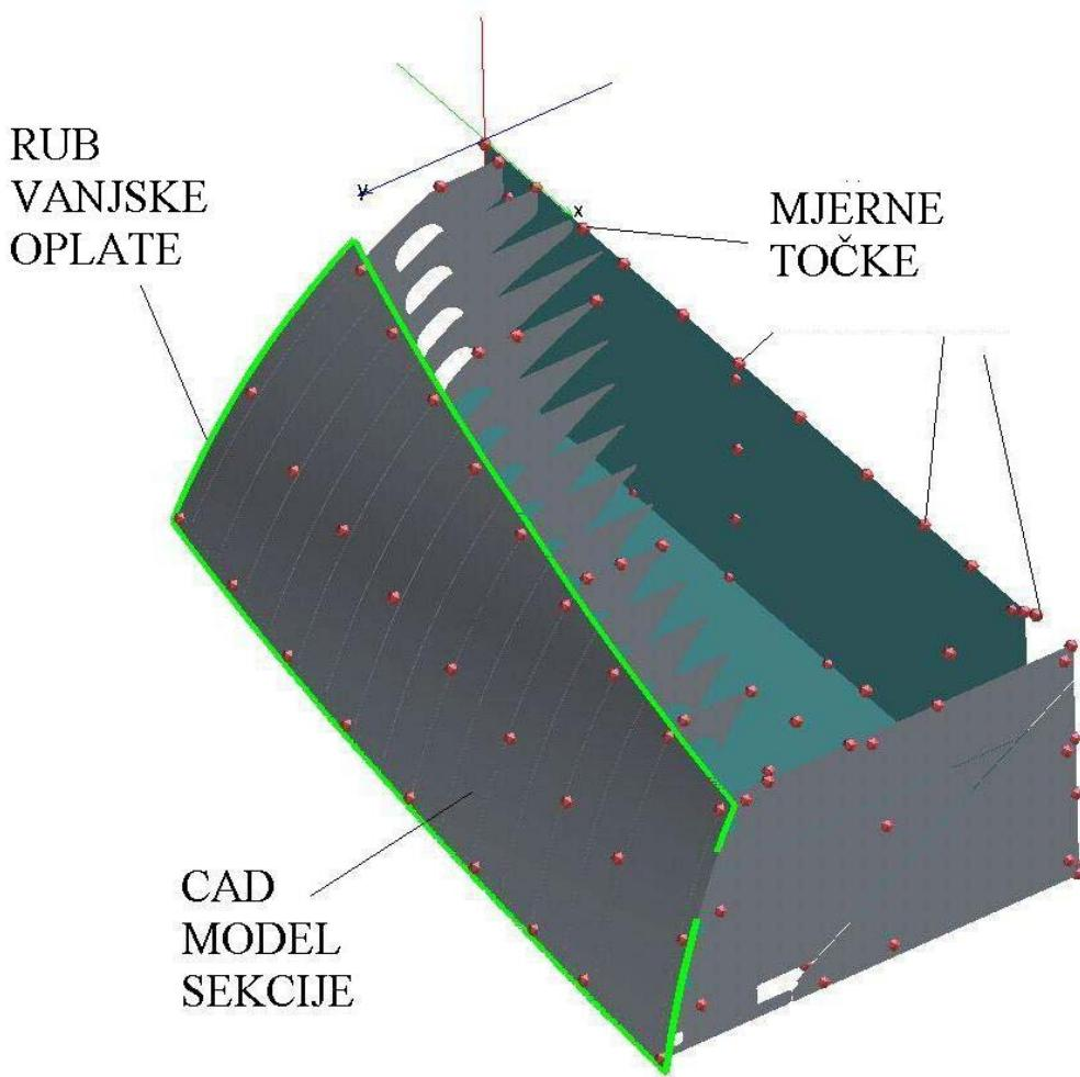
Slika 91: Preklapanje rezultata mjerena i CAD modela sekciјe
