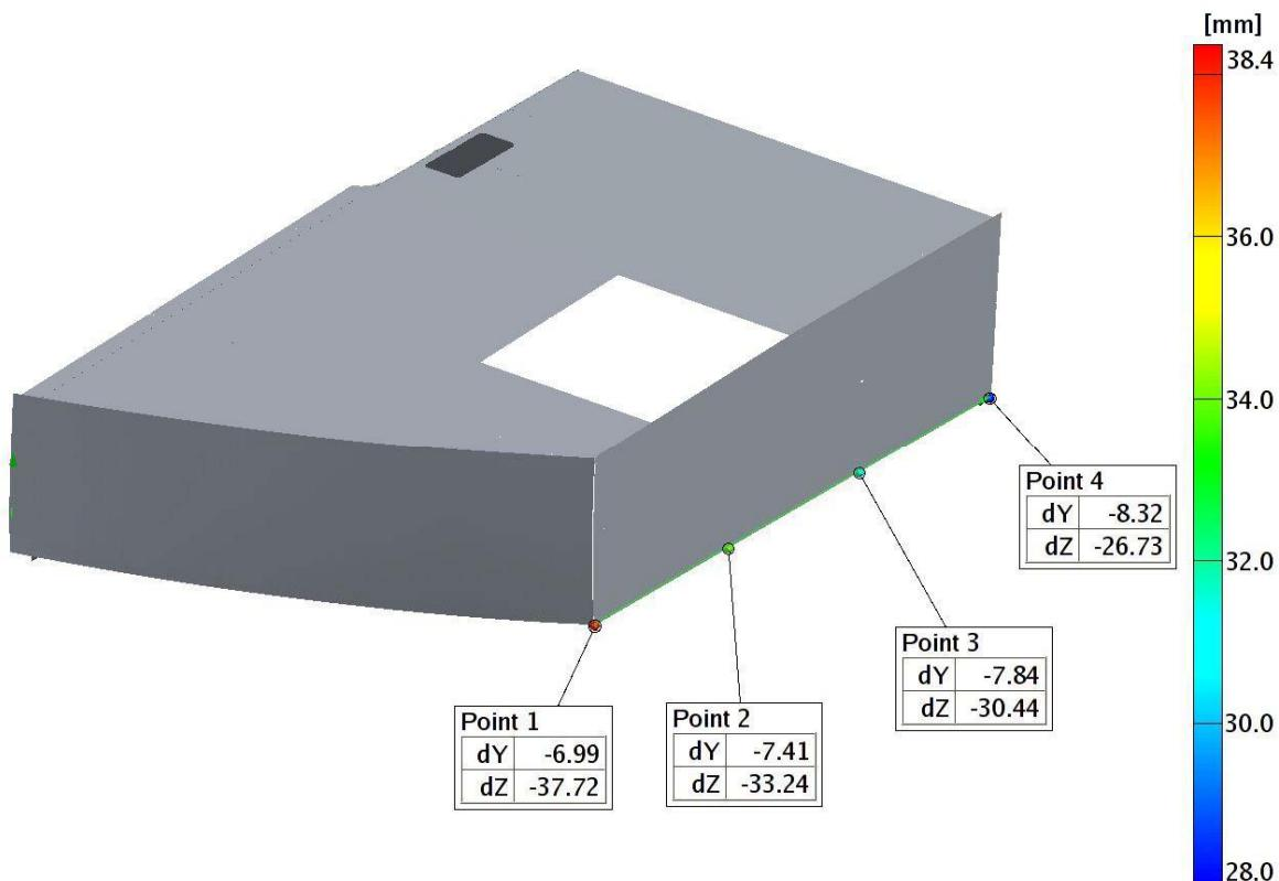
Slika 120: Analiza odstupanja mernih točaka CAD modela sekcije na krmenom zrcalu
