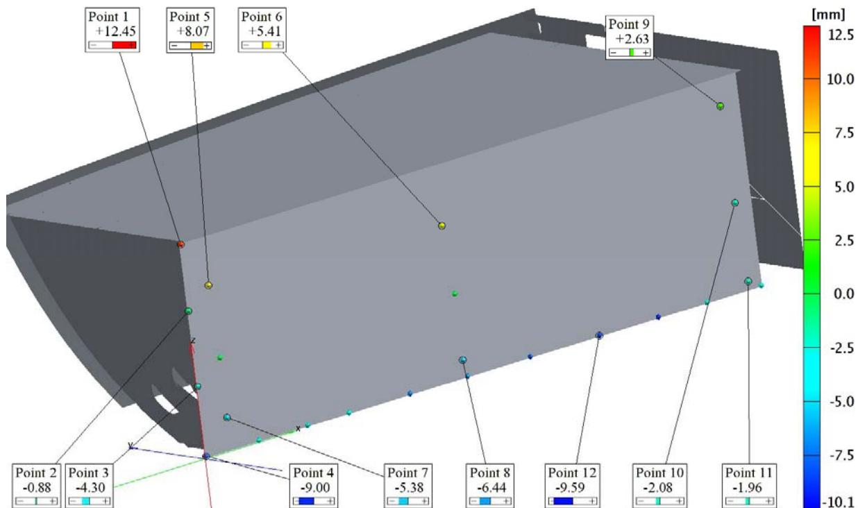
Slika 92: Odstupanja mjernih točaka uzdužne pregrade od CAD modela sekcijske
