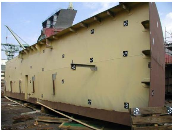
Slika 98: Mjerne točke na poprečnoj pregradi na rebru 10
