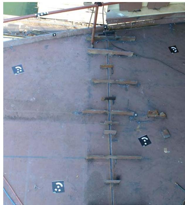
Slika 105: Mjerne točke na sekcijama svjetlog otvora
