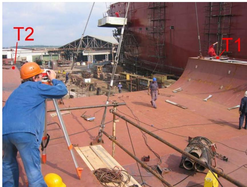
Slika 27: Kontrola poprečnog nagiba sekcijske dvodne
