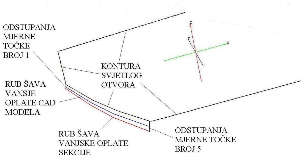
Slika 127: Odstupanja šava vanjske oplate sekcijske oplate i CAD modela od konture svjetlog otvora
