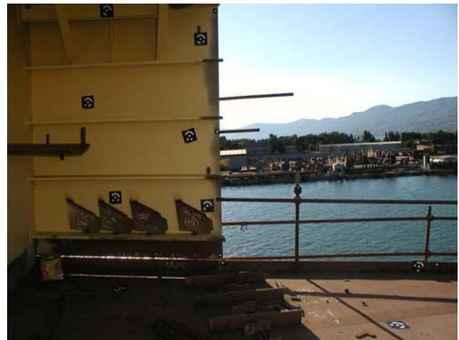
Slika 70: Postavljanje mjernih točaka na navozu
