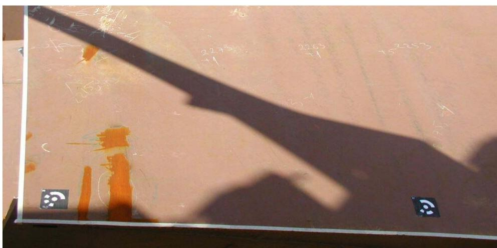
Slika 77: Postavljanje kodiranih mjernih točaka i samoljepljive trake na vanjsku oplatu sekciјe
