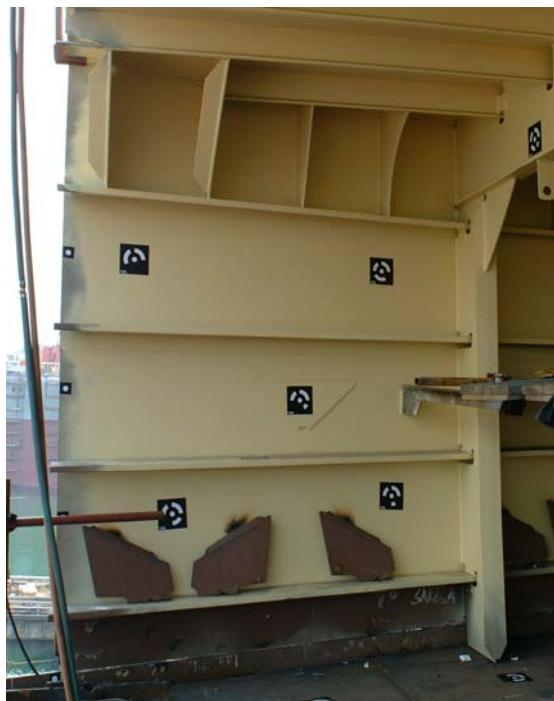
Slika 104: Mjerne točke na sekcijama svjetlog otvora
