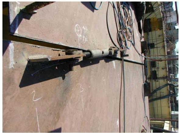
Slika 25: Mehanički pritezač za pozicioniranje sekcije
