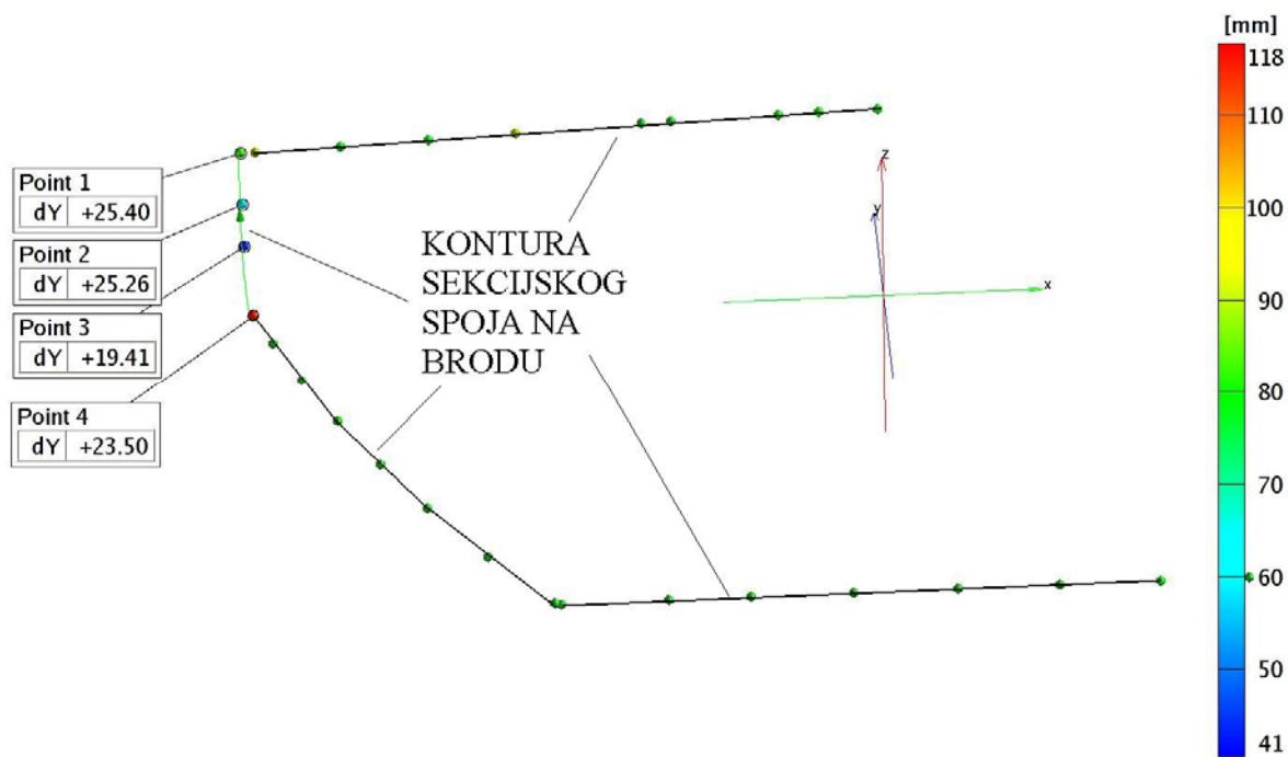
Slika 115: Odstupanja mjernih točaka sekcije na stiku vanjske oplate
