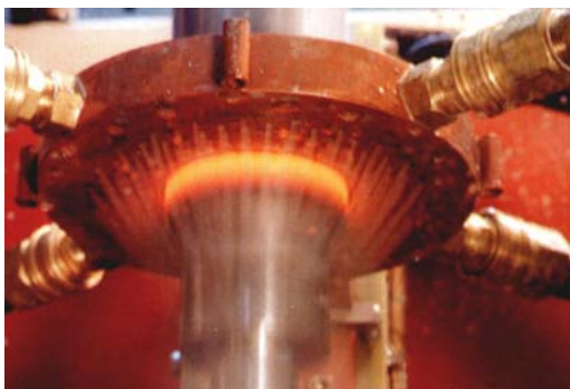
Slika 2.4 Rotaciono-posmično indukcijsko kaljenje osovine uz gašenje prskanjem
