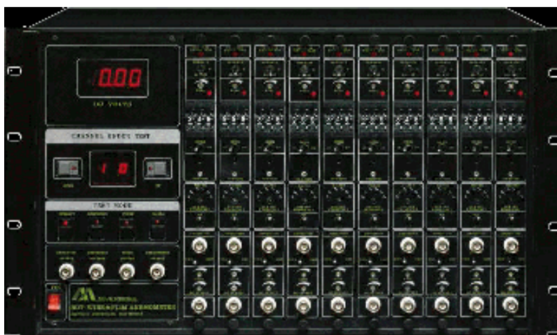
Slika 4.16: AALAB AN 1003 anemometar konstantne temperature (CTA)
