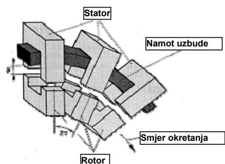
Slika 2.8 Princip izvedbe motora s transverzalnim protokom sa statorskom uzbudom
