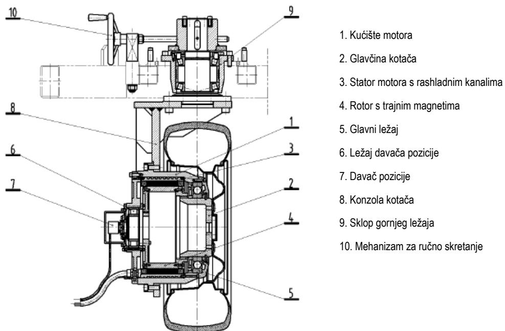
Slika 3.9 Sklop pogonskog kotača eksperimentalnog vozila
