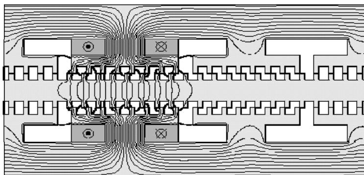
Slika 2.9 Princip izvedbe visokopoljnog reluktantnog motora s efektom brida
