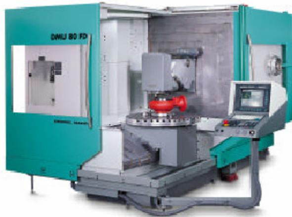
Slika 3.4 Kombinacija CNC glodaćeg i tokarskog alatnog stroja /9/
