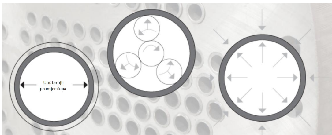
Slika 47. Princip čepljenja tehnikom rolanja [32]
