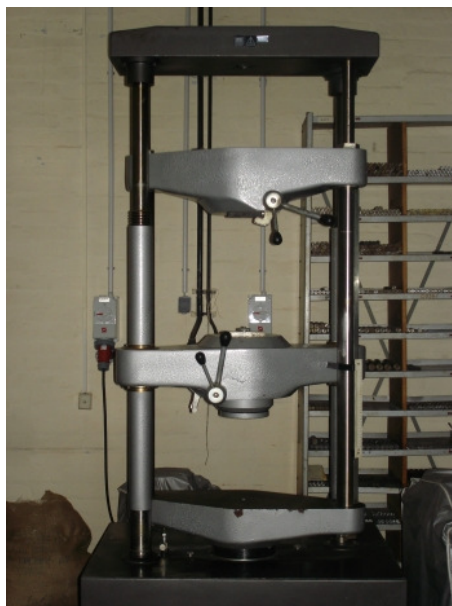
Slika 54: Univerzalna kidalica EU 40mod
