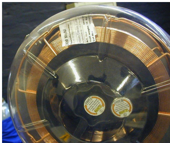
Slika 48: Kolut dodatnog materijala LNM MoNi
