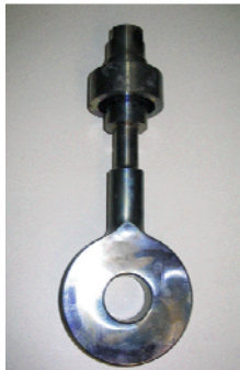
Slika 30. Posebna izvedba roga za ispitivanje učinkovitosti ultrazvuka velike snage u protočnom eksperimentalnom sustavu
