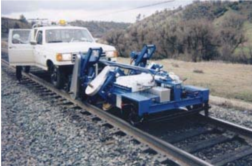
Slika 2.1.4. Tribometar za ispitivanje željezničkih tračnica.
