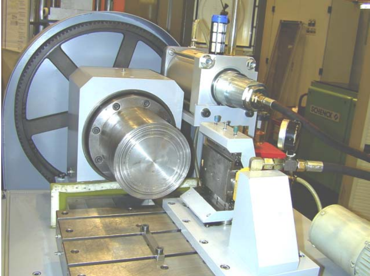
Slika 2.1.2. Primjer tribometra kod kojeg testni valjak kliže po referentnoj ploči. (Na slici referentna ploča nije prikazana).
