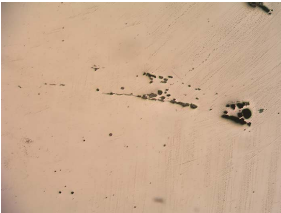
Slika 4.44 Niz uključaka u metalu zavora- uzorak F135, povećanje 50x, polirano stanje
