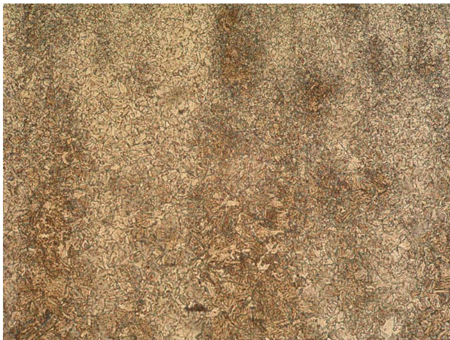
Slika 4.35 Prijelaz sitnozrnatog u grubozrnati ZUT - uzorak IB21, povećanje 200x
