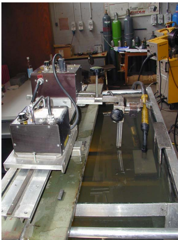
Slika 3.15 Postav opreme za podvodno mokro zavarivanje uzoraka za Implant test
