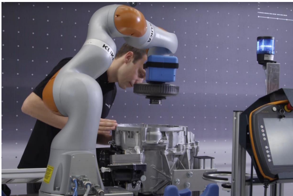
Slika 2. Kolaboracija robota i čovjeka u radnoj stanici za montažu (Daimler Benz) [8]
