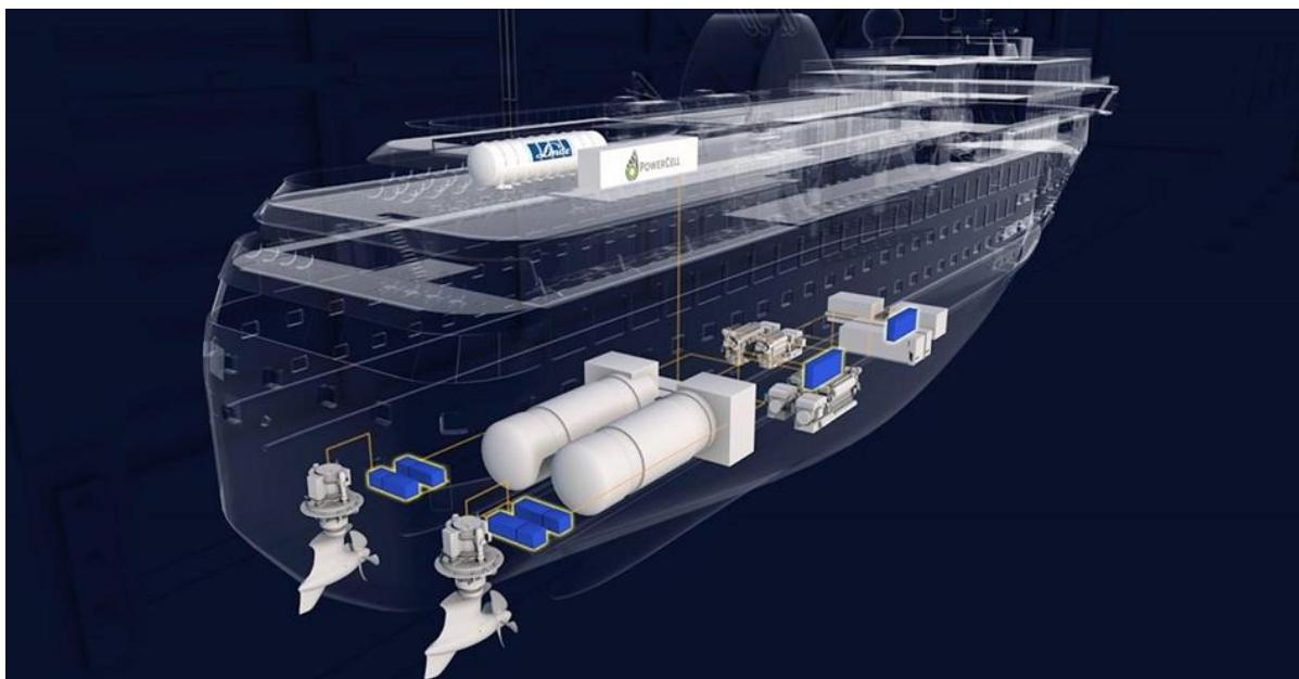
Slika 12: Brod pogonjen vodikom i njegovi osnovni dijelovi [39].
