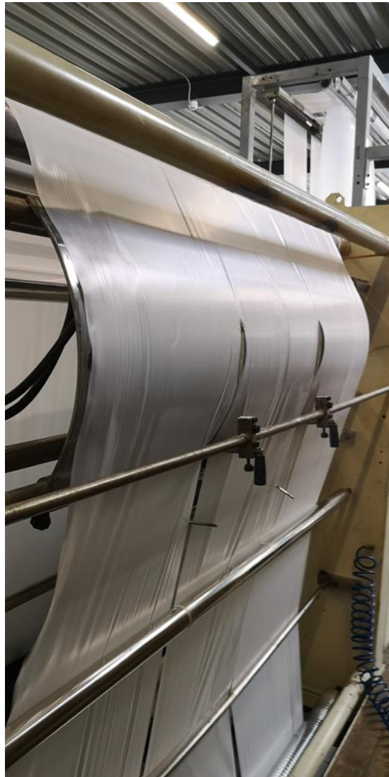
Slika 3.11. Rezanje crijevnog filma na tri jednake širine
