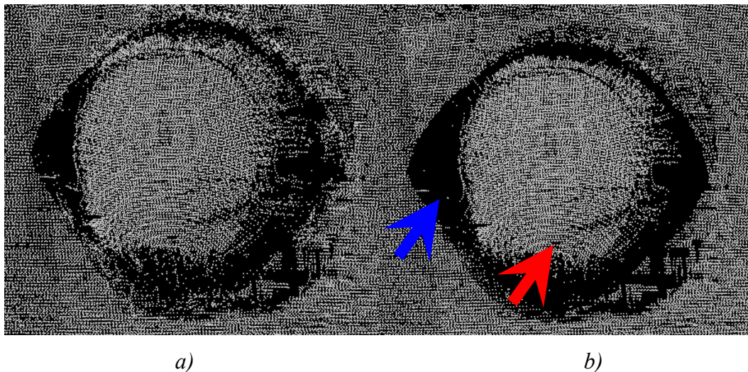
Slika 9.12. Triangulacija kombinacijom 1,2,3,4 analize i 4-3-2 triangulacije za točke čija je devijacija triangulacije a) 4\sigma , b) 1\sigma .
