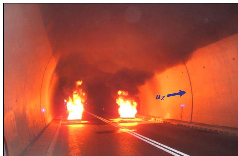
**Foto 7:** Razvoj stratifikacije dima u početnoj fazi požarnog testa,  $u_z = 0,7 \text{ m/s}$
