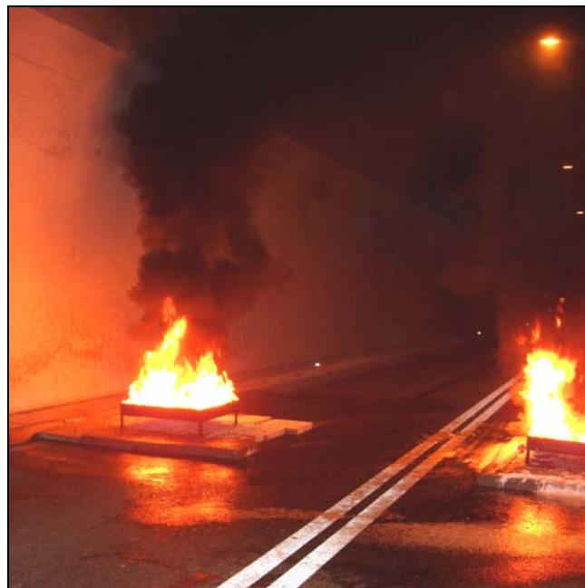
**Foto 6:** Generiranje dima neposredno nakon zapaljenja gorive smjese,  $u_z = 0 \div 0,5 \text{ m/s}$
