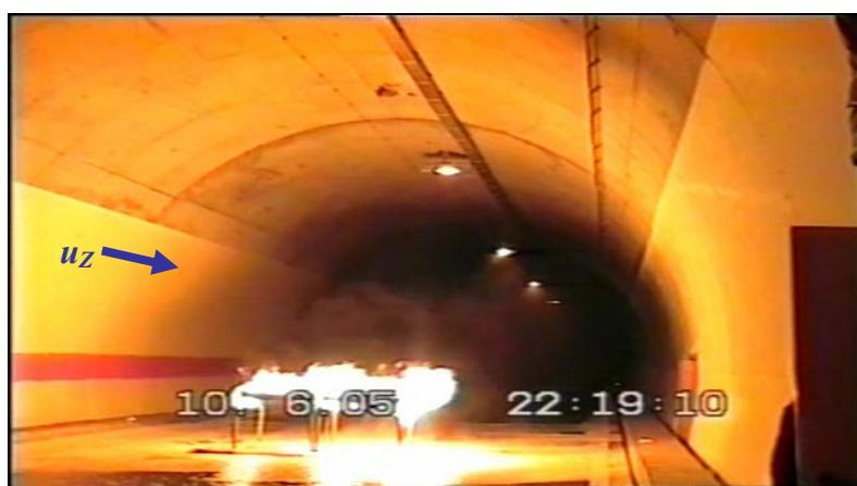
Foto 4: Startanje požarnog testa,  $u_z = 3,9 \text{ m/s} \rightarrow$  zadimljenje poprečnog presjeka
