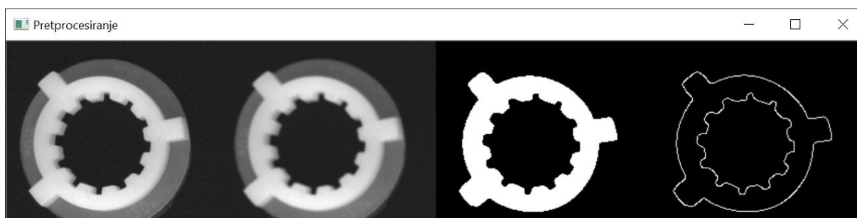
Slika 5.7 Faza segmentacije i izdvajanja značajki
