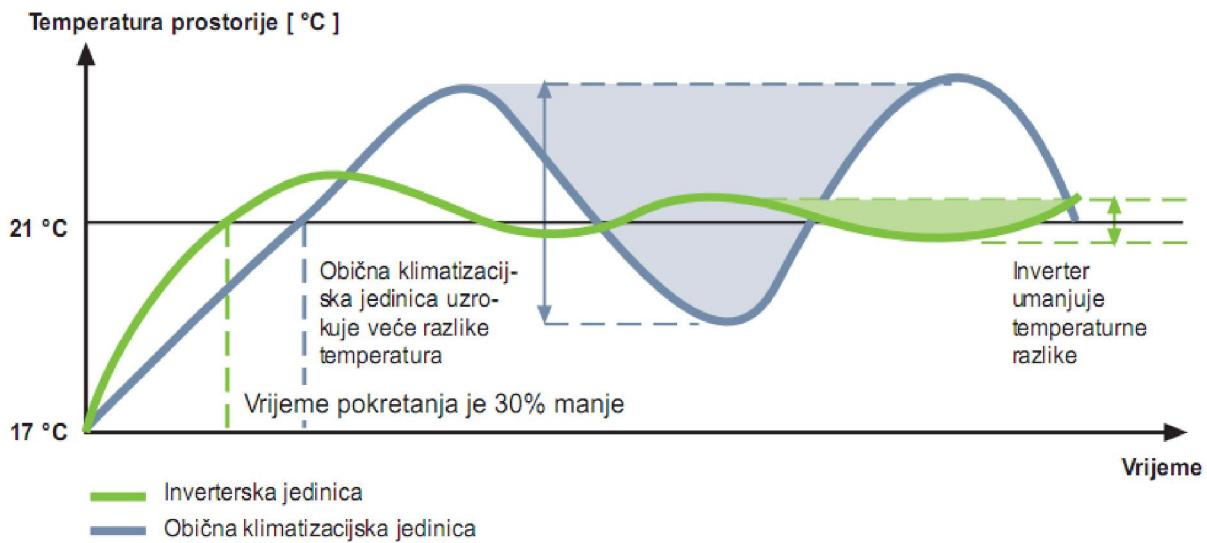
Slika 1. Usporedba inverterske i obične klimatizacijske jedinice
