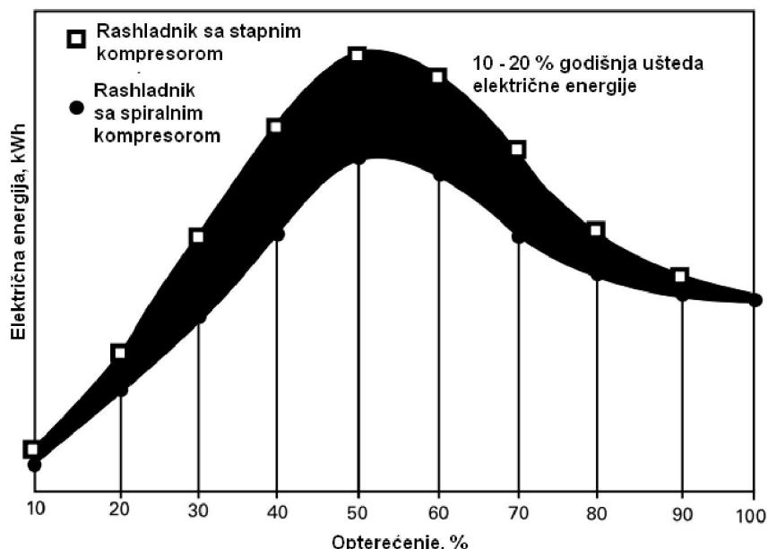
Slika 22. Ušteda električne energije rotacijskog kompresora u odnosu na stupne kompresore [10]
