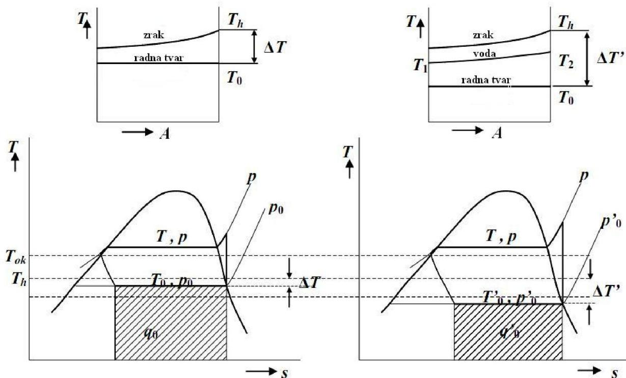
Slika 9. Usporedba procesa direktnog i indirektnog sustava hlađenja [9]
