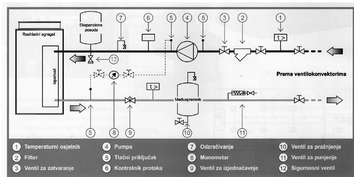
Slika 7. Hidraulička shema zrakom hlađenog rashladnog aggregata za komfornu primjenu [8]
