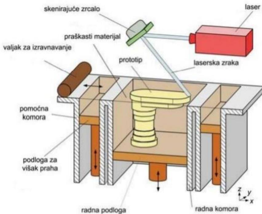
**Slika 1** Postupak selektivnog laserskog srašćivanja metalnog praha [11]
