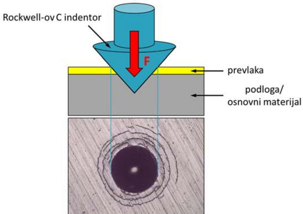
**Slika 20      Shematski prikaz mjerjenja prionjivosti prevlake HRC metodom [3]**
