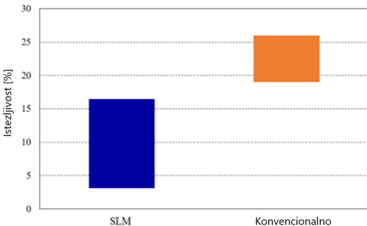
**Slika 4** Usporedba istezljivosti za Ti6Al4V proizведен 3D printanjem i konvencionalno [28]
