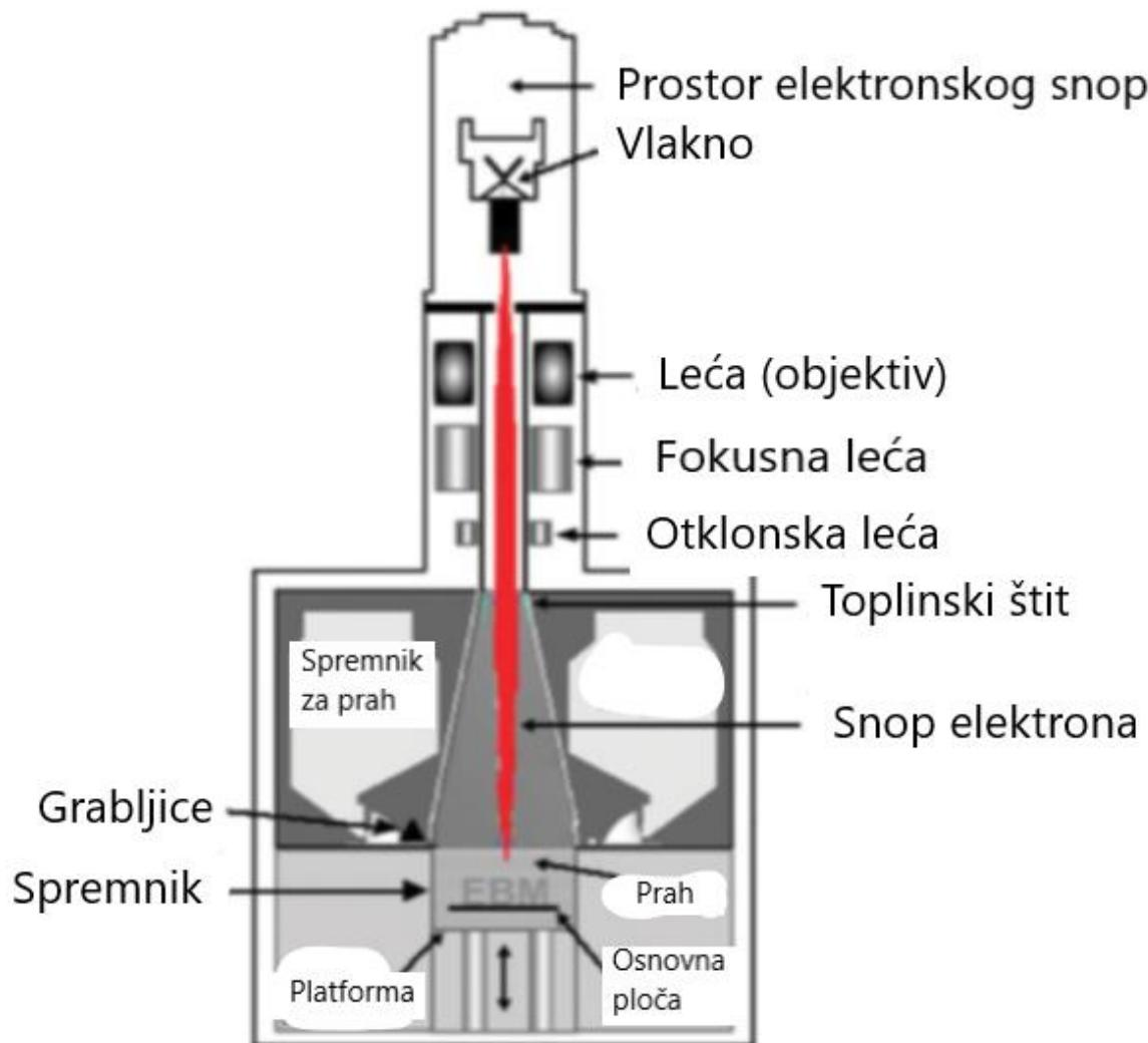
Slika 2 Postupak taljenja metalnog praha snopom elektrona
