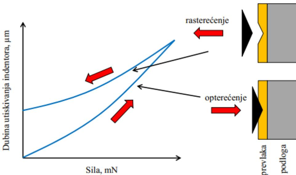
**Slika 13**      ispitivanje nanotvrdoće tankih tvrdih prevlaka [3]
