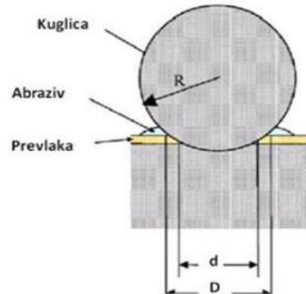
Slika 26 Ispitivanje debljine prevlake kalotestom
