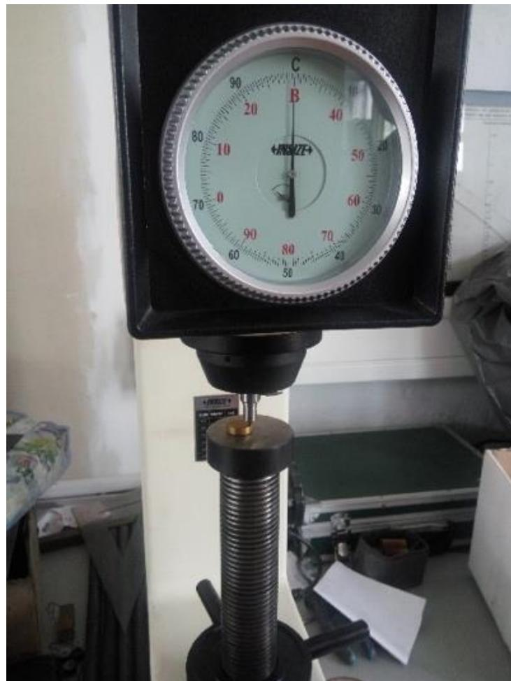
**Slika 21 Ispitivanje adhezivnosti prevlake TiN na Rockwell-ovom tvrdomjeru**
