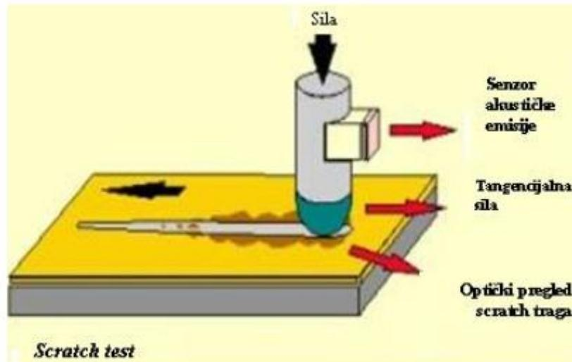
**Slika 14** Shematski prikaz uređaja za ispitivanje prevlaka brazdanjem [14]
