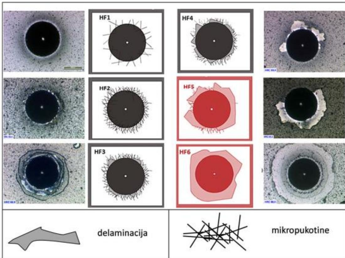
Slika 22 Šest razreda klasifikacije mjerena prionjivosti prevlake metodom HRC [3]
