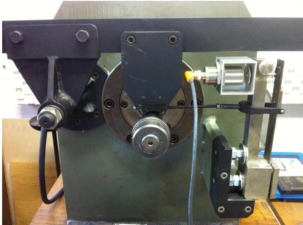
Slika 29 Uredaj za ispitivanje otpornosti na adhezijsko trošenje
