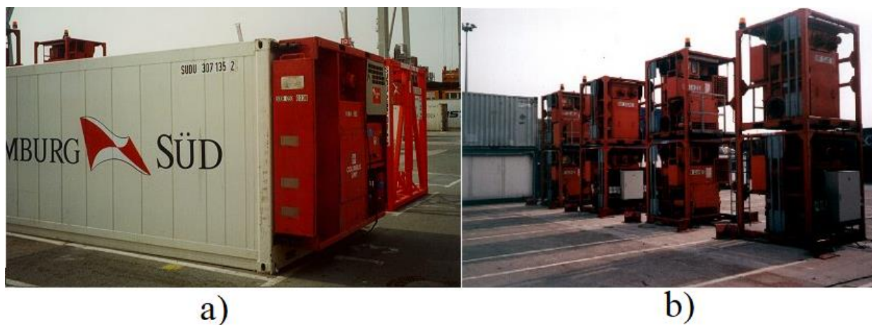
Slika 14. a) kompaktna prijenosna rashladna jedinica (clip on unit) b) prijenosne rashladne jedinice za više kontejnera [17], [18]
