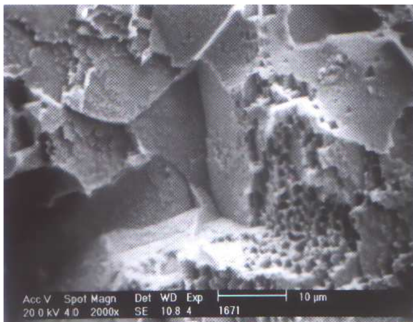
Slika 77. Željezna elektroda nakon obrade u \text{HNO}_3 i nanošenja BTSPS monosloja (2000x); vidljivi tragovi nagrizanja kiseline
