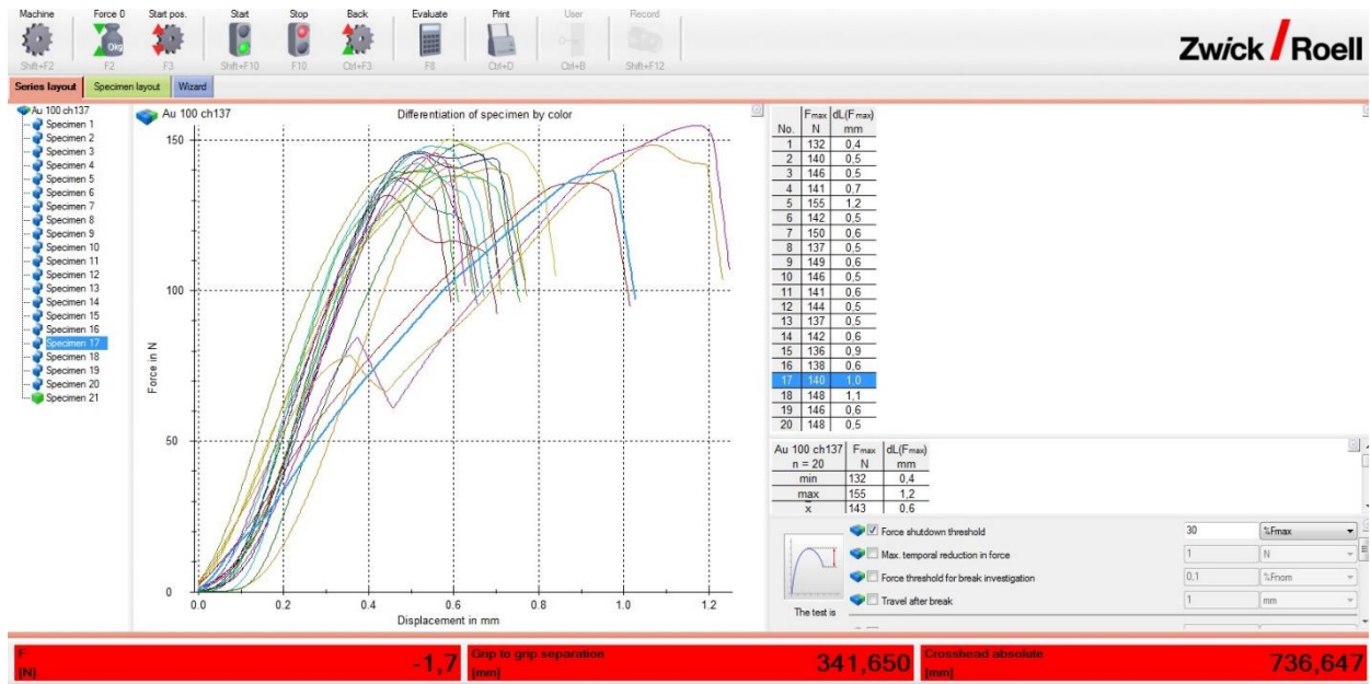
Dijagram sila-produljenje za 1,00 mm 2 žicu, 1,35 mm visina steznog spoja, prevlaka zlatna
