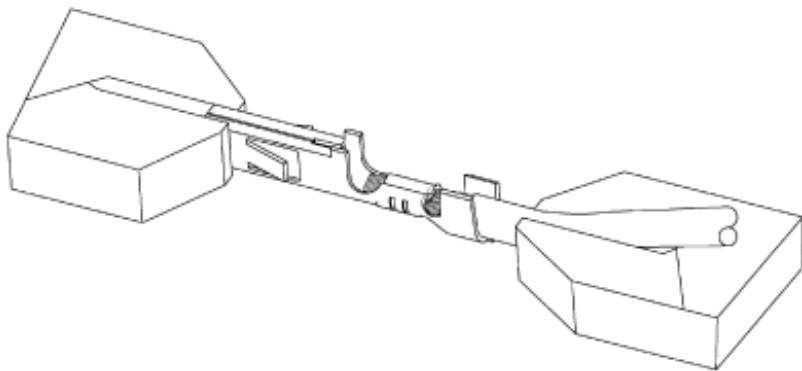
**Slika 41. Ispitivanje vlačne čvrstoće [32]**
