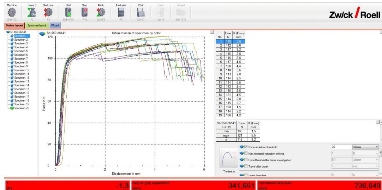
Dijagram sila-produljenje za  $0,50 \text{ mm}^2$  žicu,  $1,43 \text{ mm}$  visina steznog spoja, prevlaka kositra
