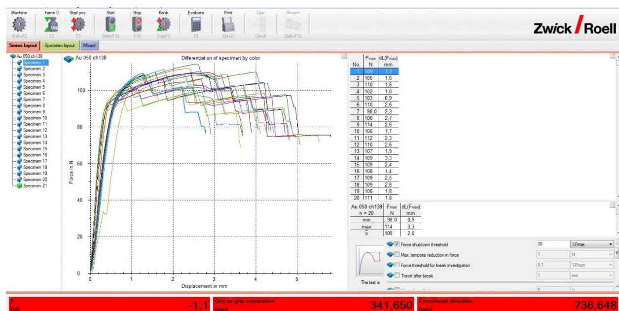
Dijagram sila-produljenje za  $0,50 \text{ mm}^2$  žicu, 1,39 mm visina steznog spoja, prevlaka zlatna
