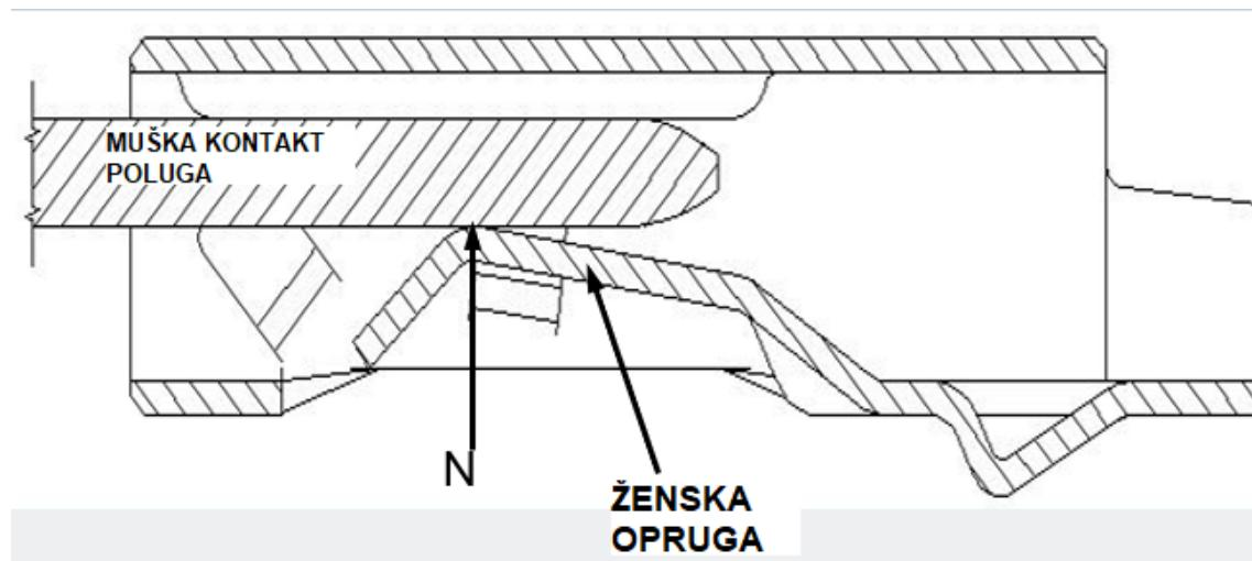
Slika 13. Presjek kontakta (spoja) muškog i ženskog terminala [18]
