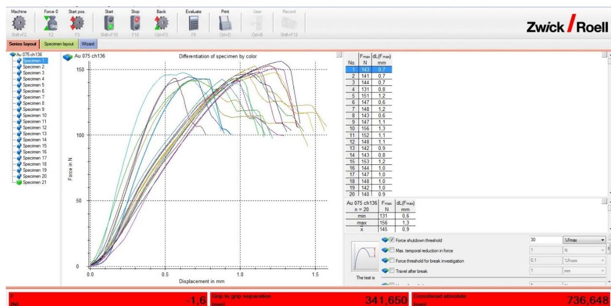
Dijagram sila-produljenje za  $0,75 \text{ mm}^2$  žicu,  $1,35 \text{ mm}$  visina steznog spoja, prevlaka zlatna
