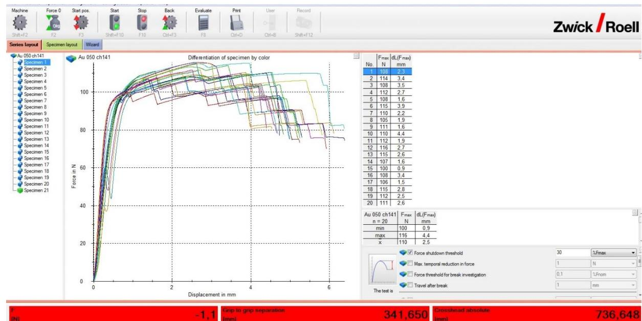
Dijagram sila-produljenje za  $0,50 \text{ mm}^2$  žicu,  $1,43 \text{ mm}$  visina steznog spoja, prevlaka zlatna
