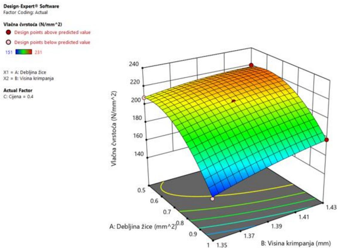
**Slika 51.** Prikaz odzivne površine čvrstoće pri promjeni visine spoja i debljine žice
