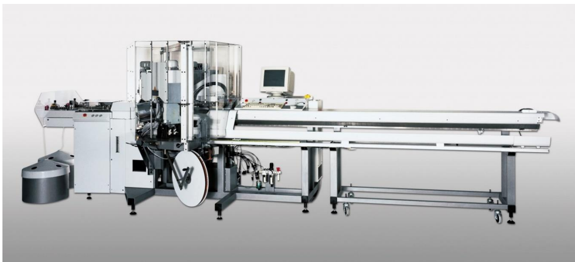
Slika 28. Potpuno automatiziran stroj za stezno spajanje vodiča [29]
