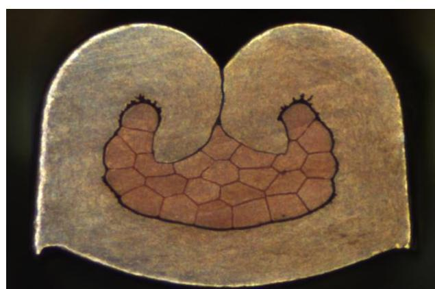
**Slika 60. Poprečni presjek unutarnje površine zone steznog spoja vodiča**
