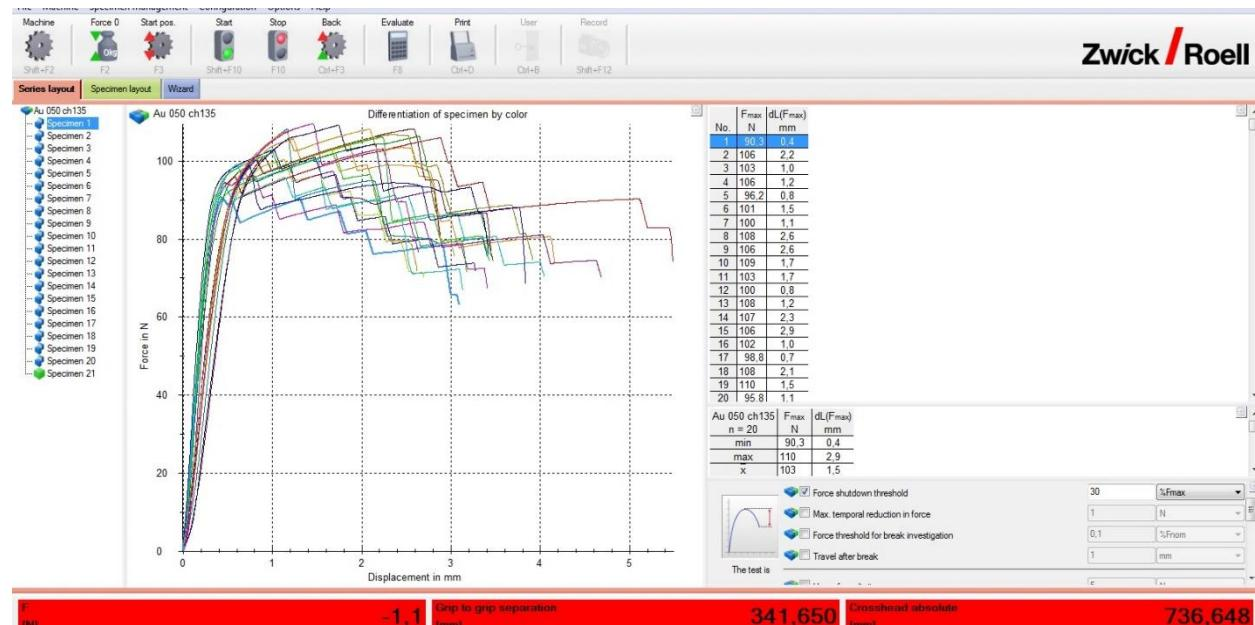
Dijagram sila-produljenje za  $0,50 \text{ mm}^2$  žicu, 1,35 mm visina steznog spoja, prevlaka zlatna
