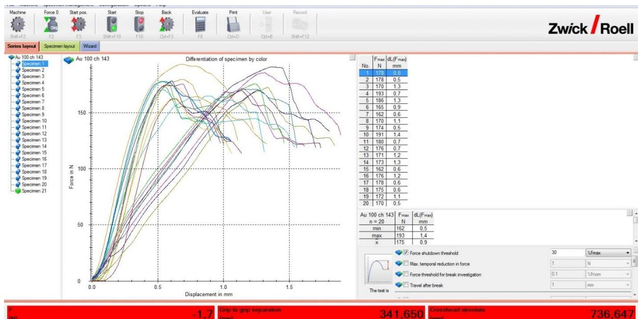
Dijagram sila-produljenje za  $1,00 \text{ mm}^2$  žicu,  $1,43 \text{ mm}$  visina steznog spoja, prevlaka zlatna
