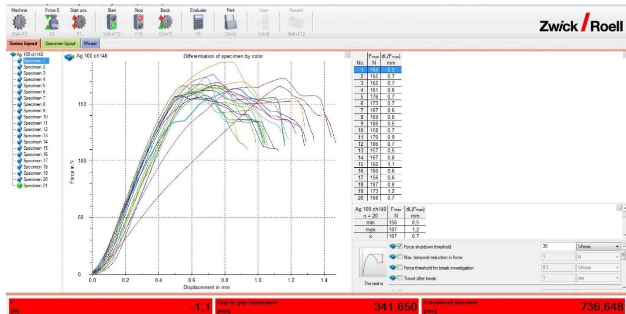
Dijagram sila-produljenje za 1,00 mm<sup>2</sup> žicu, 1,39 mm visina steznog spoja, prevlaka srebra
