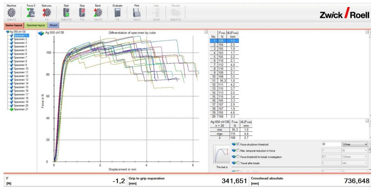
Dijagram sila-produljenje za  $0,50 \text{ mm}^2$  žicu, 1,39 mm visina steznog spoja, prevlaka srebra
