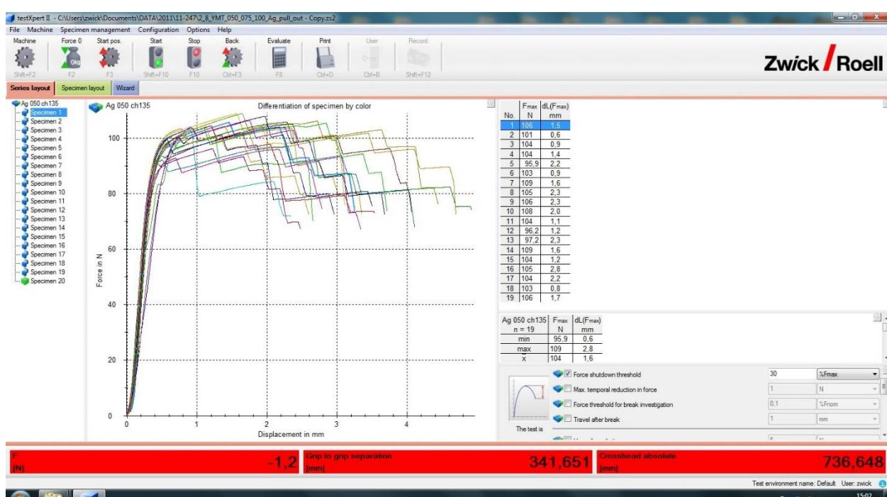
Dijagram sila-produljenje za 0,50 mm<sup>2</sup> žicu, 1,35 mm visina steznog spoja, prevlaka srebra
