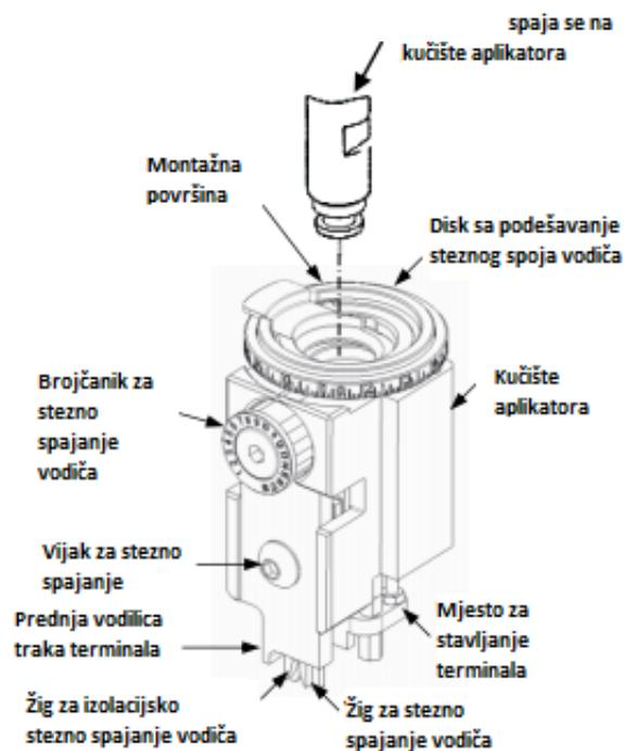
Slika 24. Dijelovi aplikatora [27]
