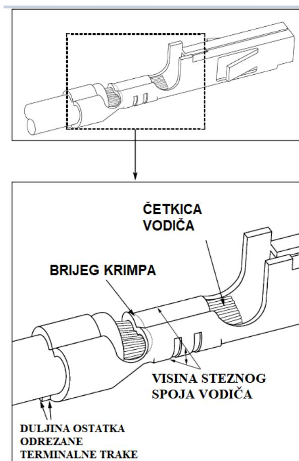
Slika 34. Dijelovi steznog spoja vodiča i izolacijskog steznog spoja vodiča, 1. dio [32]
