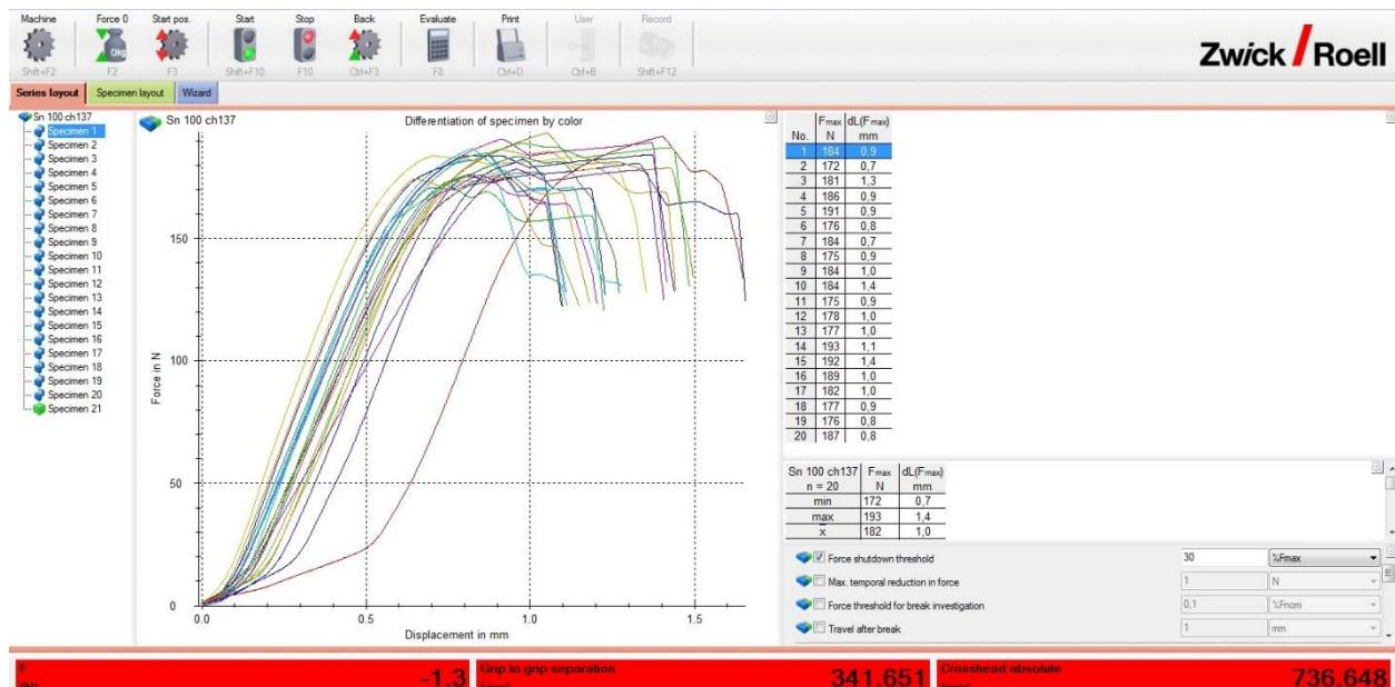
Dijagram sila-produljenje za 1,00 mm<sup>2</sup> žicu, 1,35 mm visina steznog spoja, prevlaka kositra
