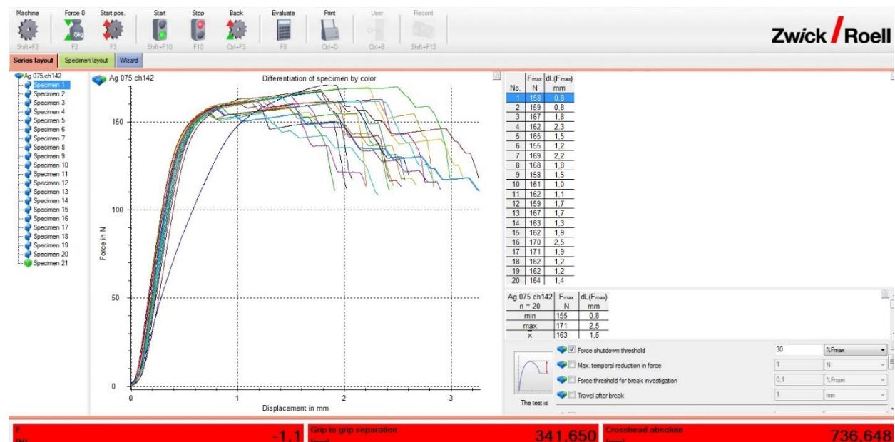
Dijagram sila-produljenje za  $0,75 \text{ mm}^2$  žicu,  $1,43 \text{ mm}$  visina steznog spoja, prevlaka srebra
