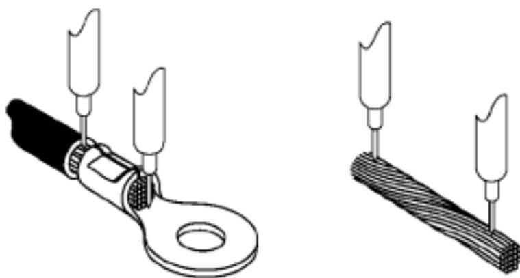
**Slika 38. Relativni otpor steznog spajanja na žicu [36]**
