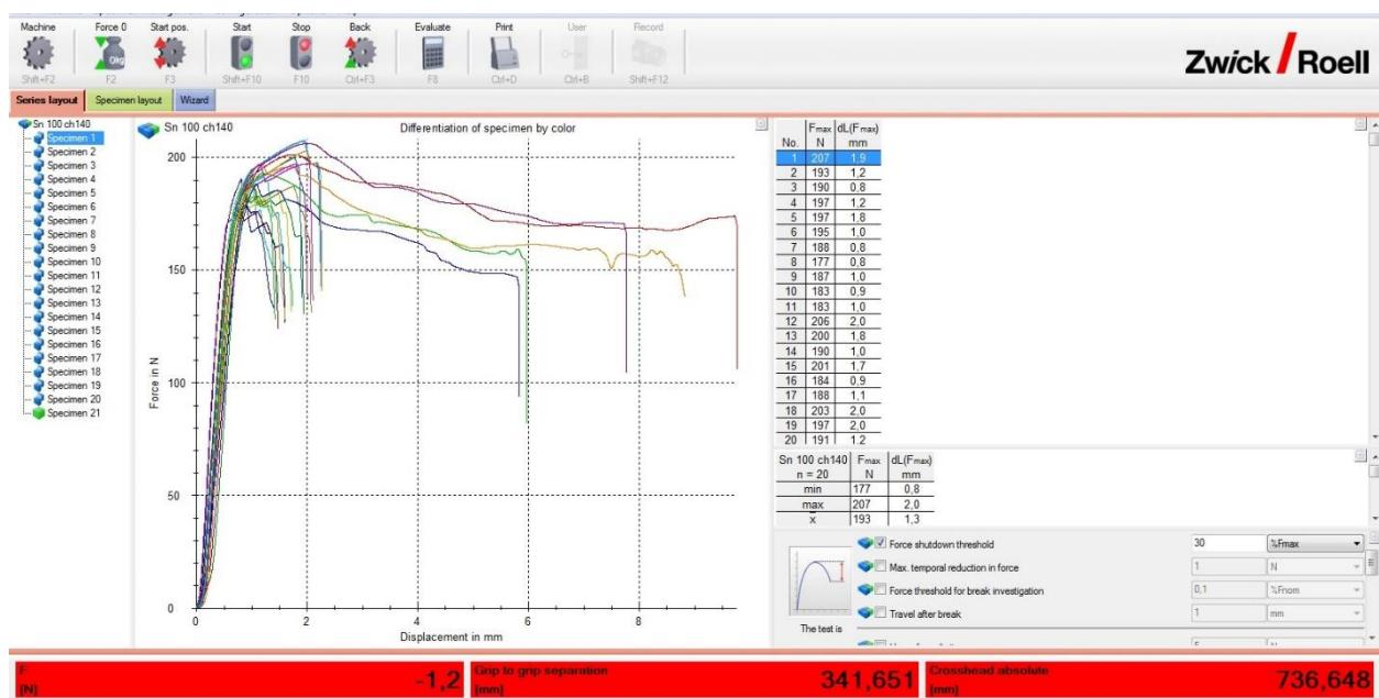
Dijagram sila-produljenje za 1,00 mm<sup>2</sup> žicu, 1,39 mm visina steznog spoja, prevlaka kositra
