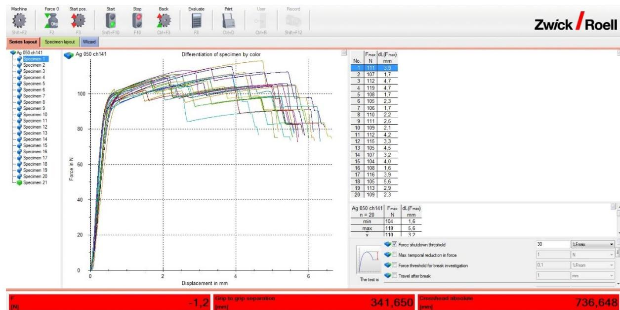
Dijagram sila-produljenje za  $0,50 \text{ mm}^2$  žicu, 1,43 mm visina steznog spoja, prevlaka srebra
