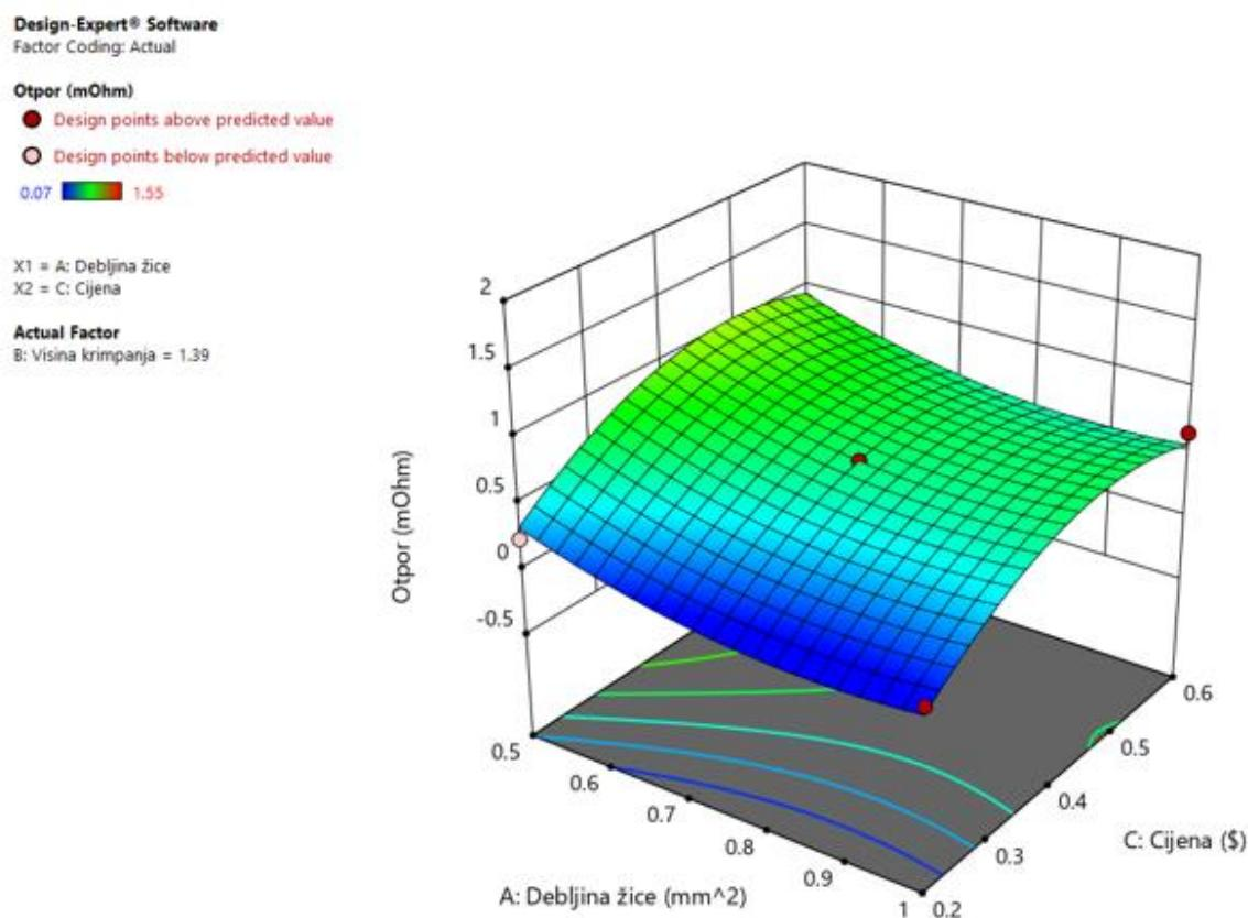
**Slika 47.** Prikaz odzivne površine otpora pri promjeni cijene i debljine žice
