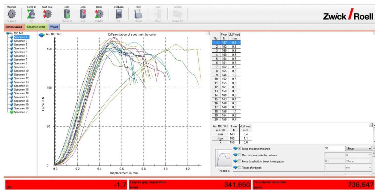
Dijagram sila-produljenje za 1,00 mm<sup>2</sup> žicu, 1,39 mm visina steznog spoja, prevlaka zlatna
