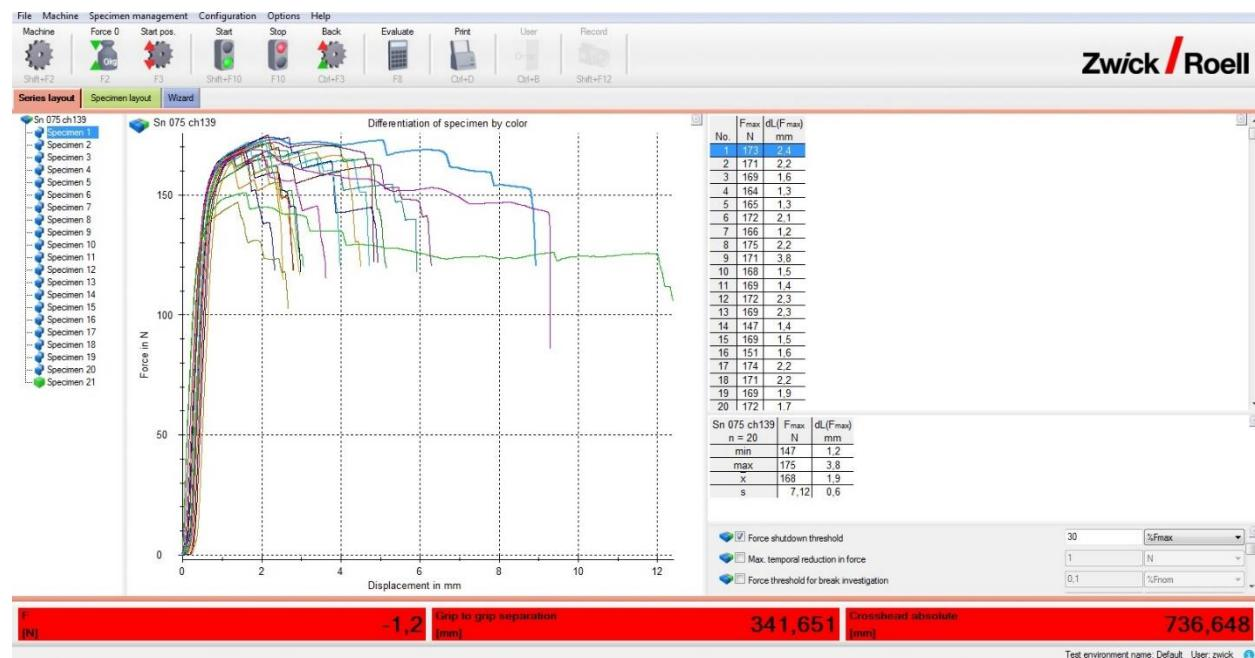
Dijagram sila-produljenje za  $0,75 \text{ mm}^2$  žicu, 1,39 mm visina steznog spoja, prevlaka kositra
