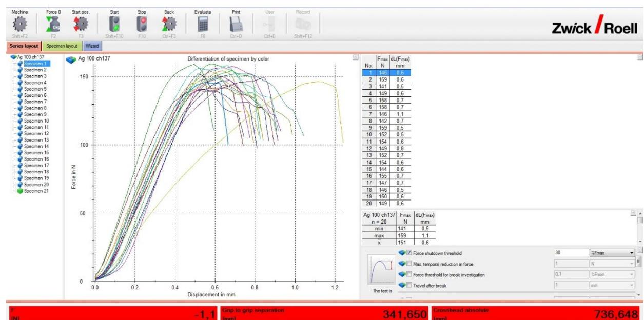
Dijagram sila-produljenje za  $1,00 \text{ mm}^2$  žicu,  $1,35 \text{ mm}$  visina steznog spoja, prevlaka srebra
