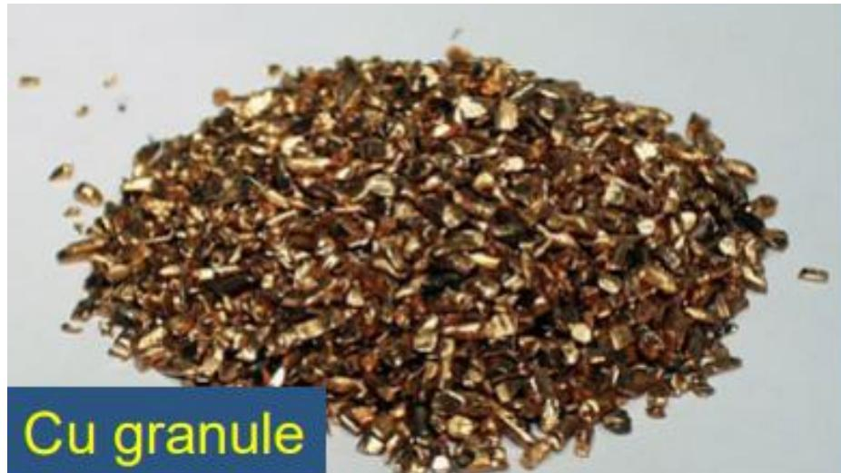
**Slika 10. Bakrene granule nakon procesa recikliranja kabela [11]**
