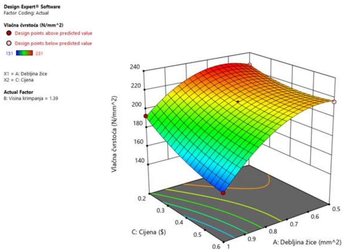
Slika 52. Prikaz odzivne površine čvrstoće pri promjeni cijene i debljine žice
