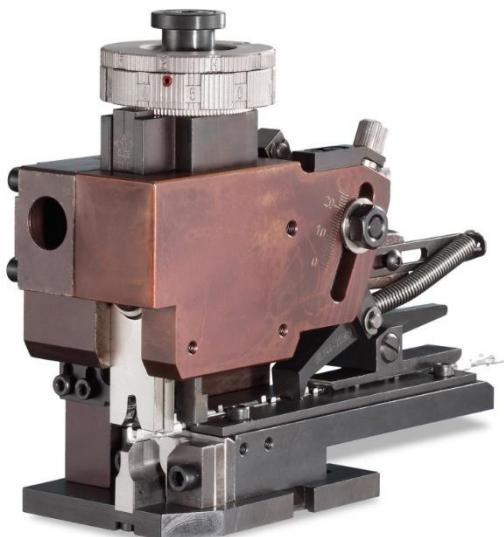
Slika 25. Aplikator s mehaničkim sustavom dovoda [28]
