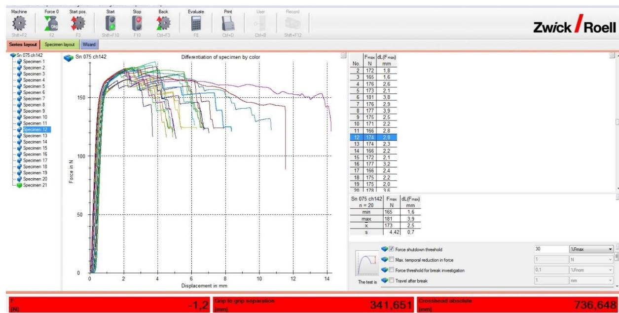
Dijagram sila-produljenje za  $0,75 \text{ mm}^2$  žicu, 1,43 mm visina steznog spoja, prevlaka kositra
