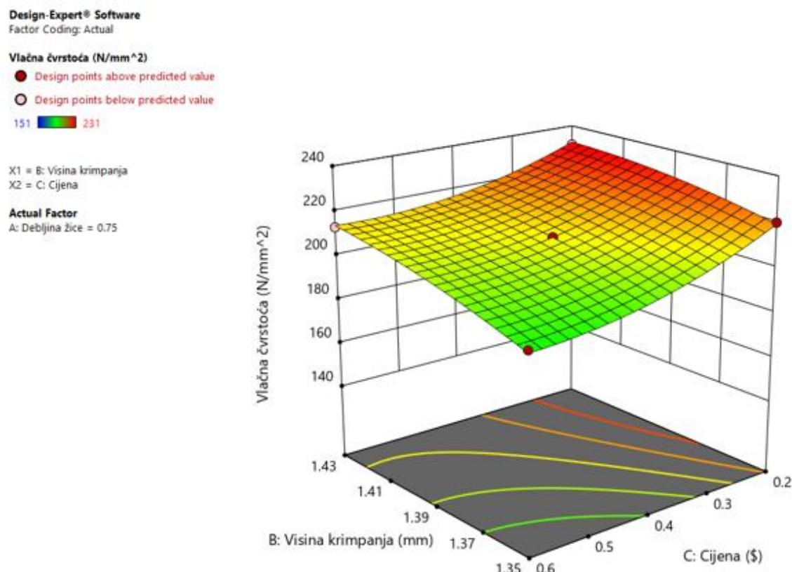
**Slika 53. Prikaz odzivne površine čvrstoće pri promjeni visine spoja i cijene**
