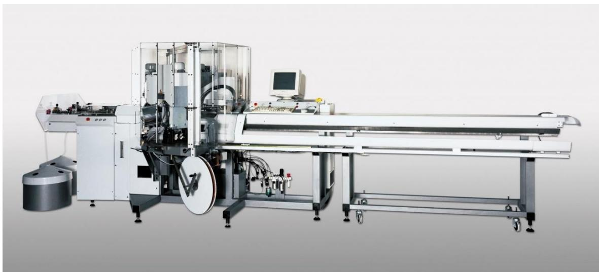
Slika 28. Potpuno automatiziran stroj za stezno spajanje vodiča [29]
