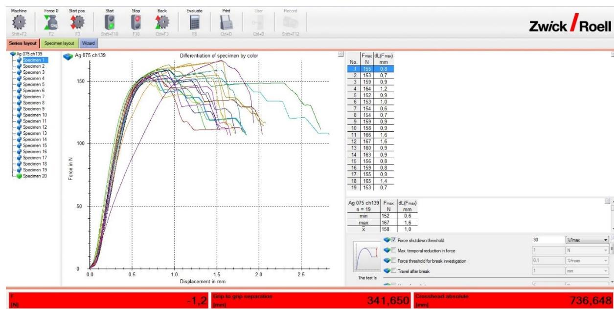
Dijagram sila-produljenje za  $0,75 \text{ mm}^2$  žicu, 1,39 mm visina steznog spoja, prevlaka srebra
