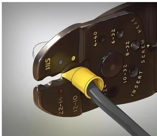
**Slika 23. Stezno spajanje terminala i kabela ručnim alatom [26]**
