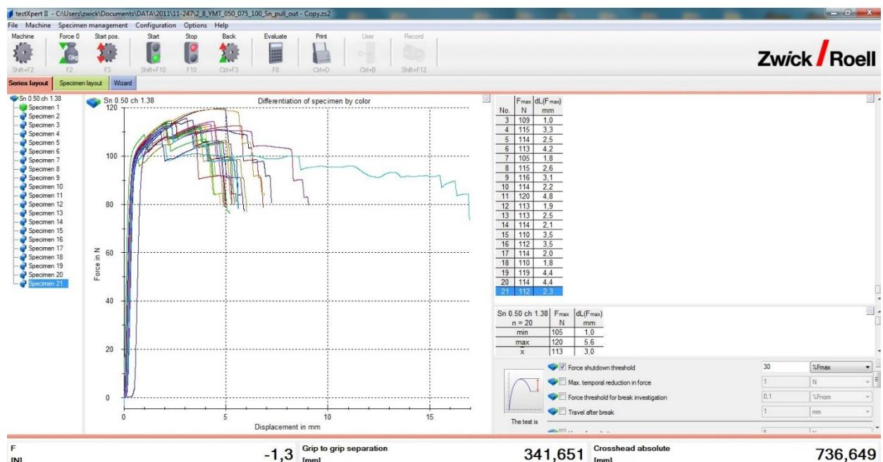
Dijagram sila-produljenje za 0,50 mm<sup>2</sup> žicu, 1,39 mm visina steznog spoja, prevlaka kositra
