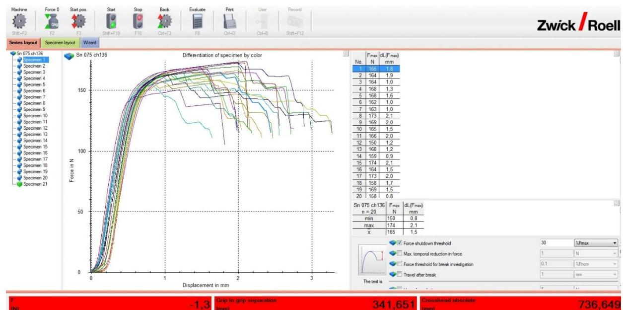
Dijagram sila-produljenje za  $0,75 \text{ mm}^2$  žicu,  $1,35 \text{ mm}$  visina steznog spoja, prevlaka kositra
