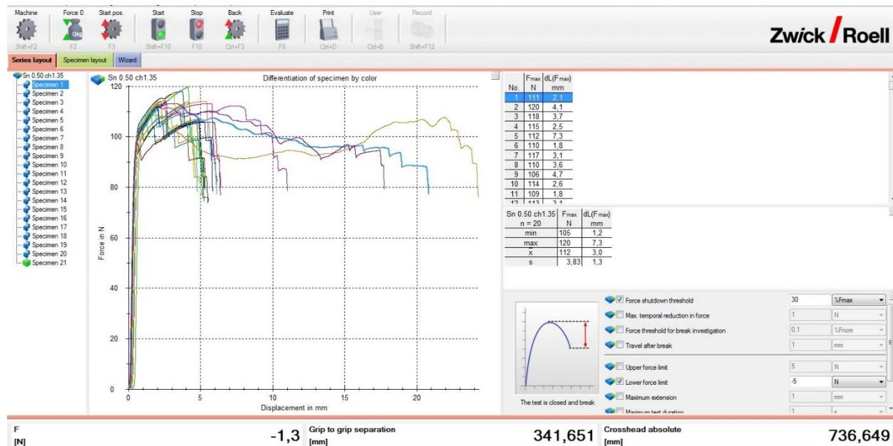
Dijagram sila-produljenje za 0,50 mm<sup>2</sup> žicu, 1,35 mm visina steznog spoja, prevlaka kositra
