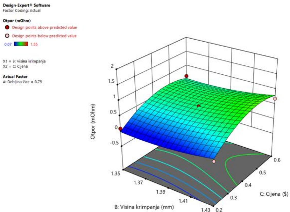
**Slika 48. Prikaz odzivne površine otpora pri promjeni visine spoja i cijene**
