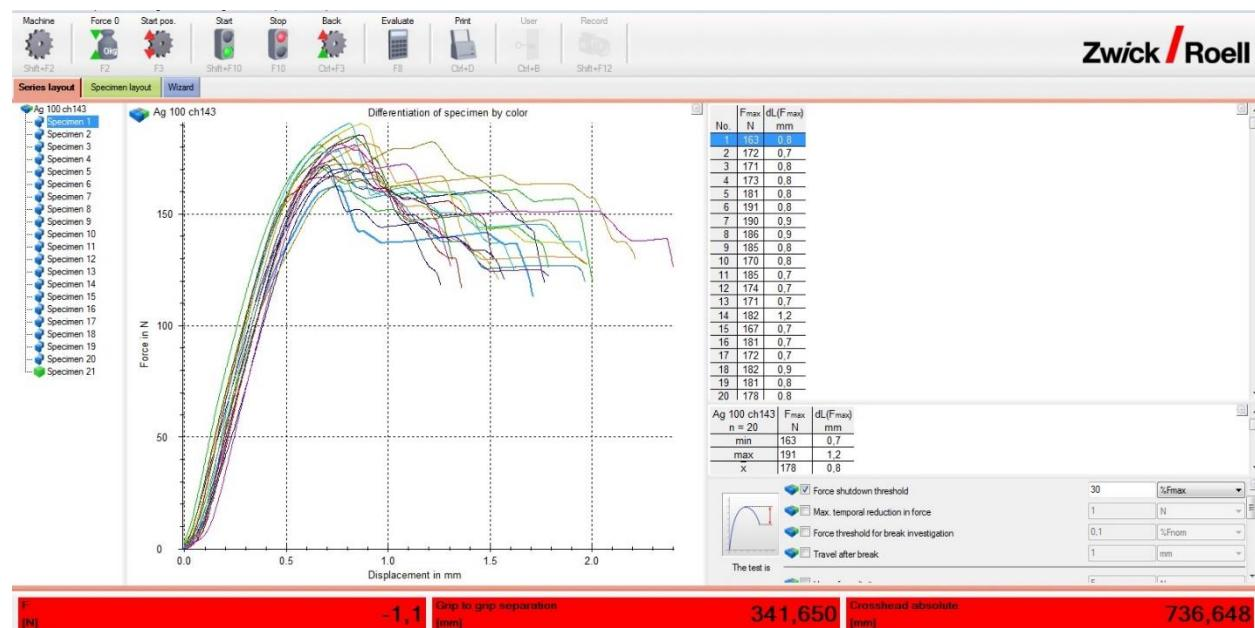
Dijagram sila-produljenje za 1,00 mm<sup>2</sup> žicu, 1,43 mm visina steznog spoja, prevlaka srebra
