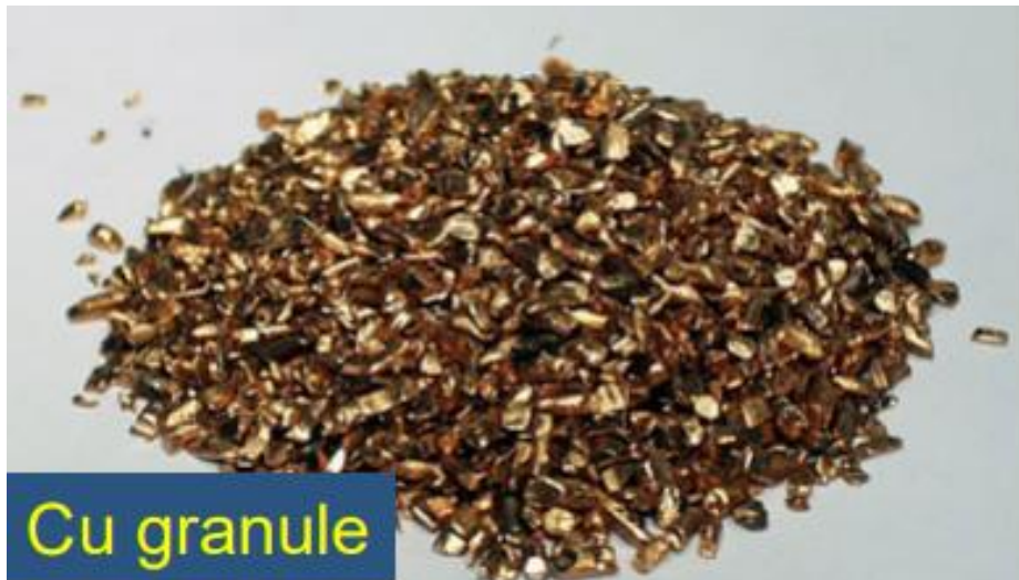
Slika 10. Bakrene granule nakon procesa recikliranja kabela [11]
