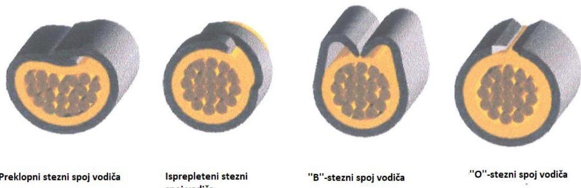
**Slika 33. Oblici izolacijskog steznog spoja vodiča [18]**
