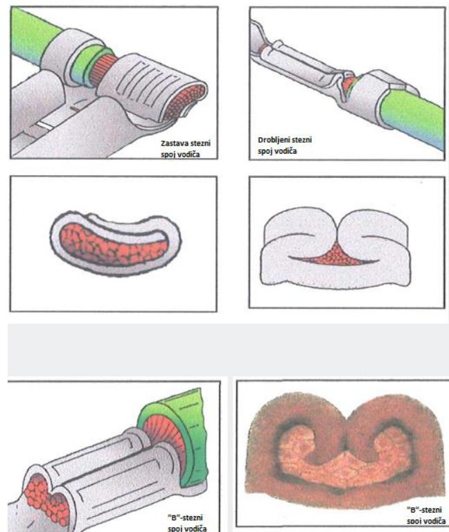
**Slika 31. Oblici steznog spoja vodiča s otvorenim krilima nakon steznog spajanja [18]**
