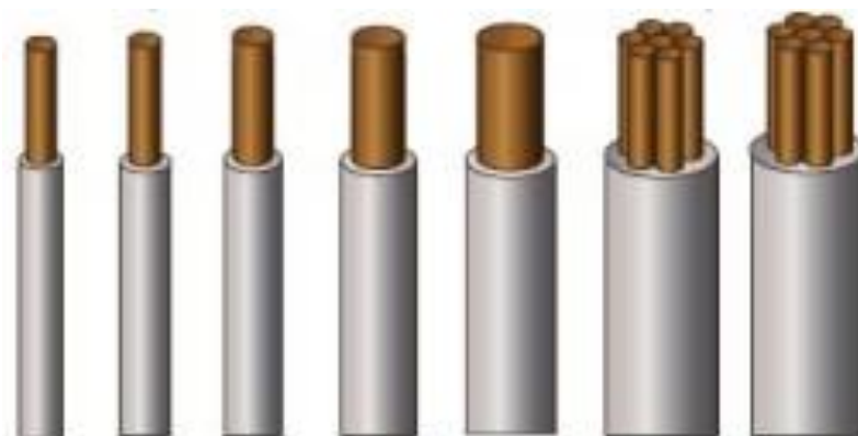
Slika 8. Različite veličine električnog vodiča [14]
