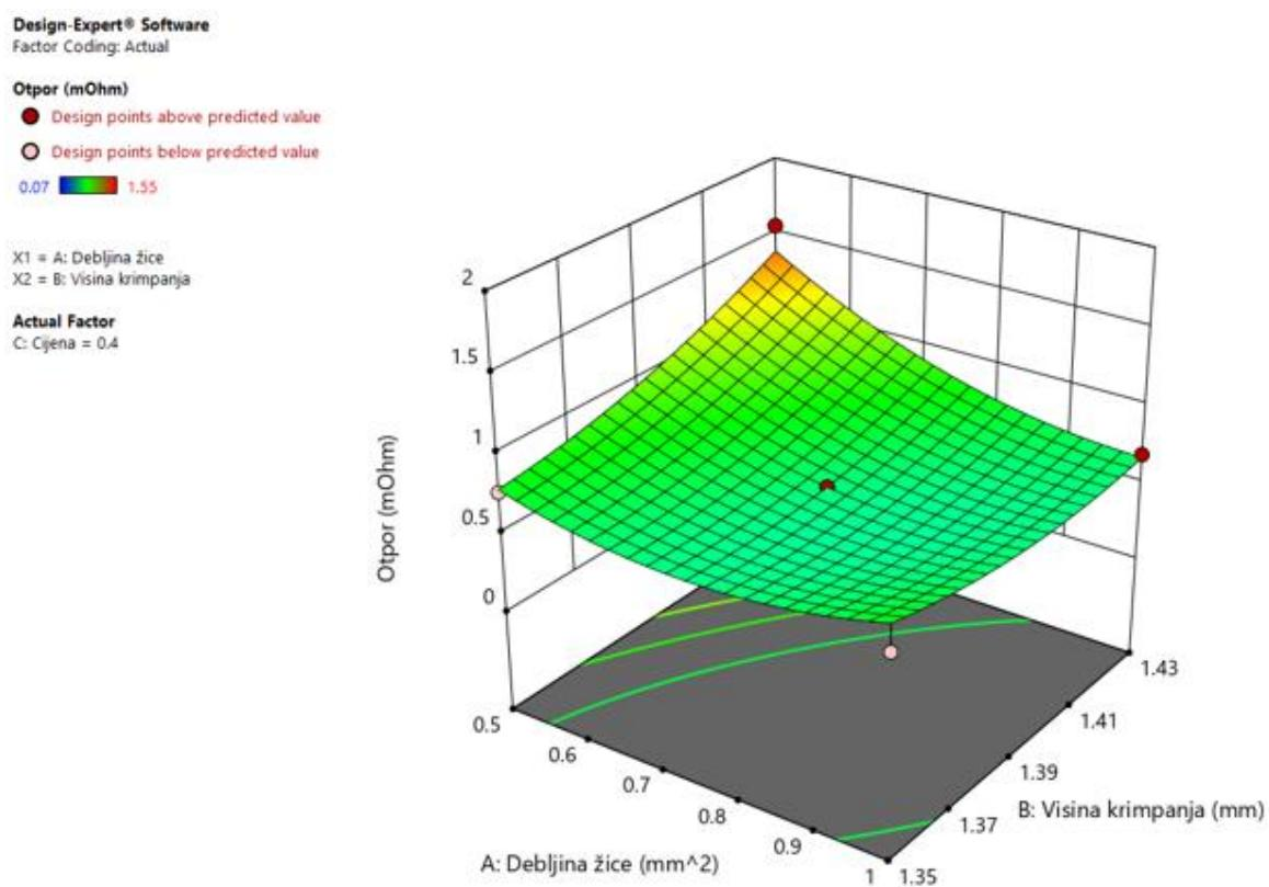
**Slika 46.** Prikaz odzivne površine otpora pri promjeni visine spoja i debljine žice
