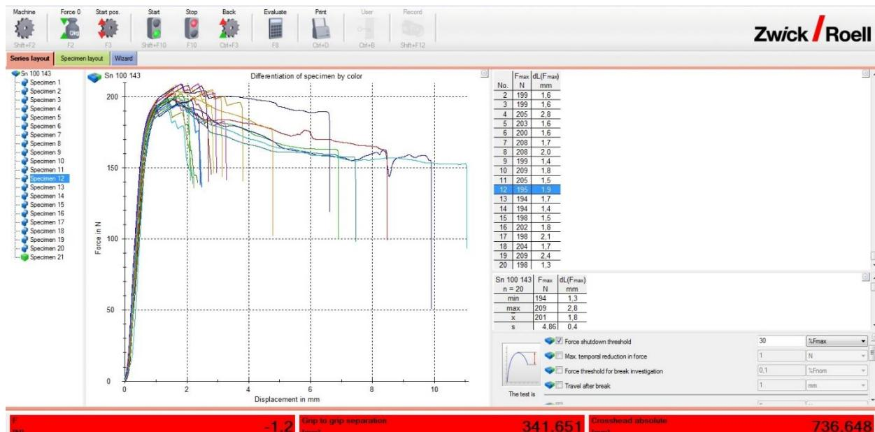
Dijagram sila-produljenje za 1,00 mm<sup>2</sup> žicu, 1,43 mm visina steznog spoja, prevlaka kositra
