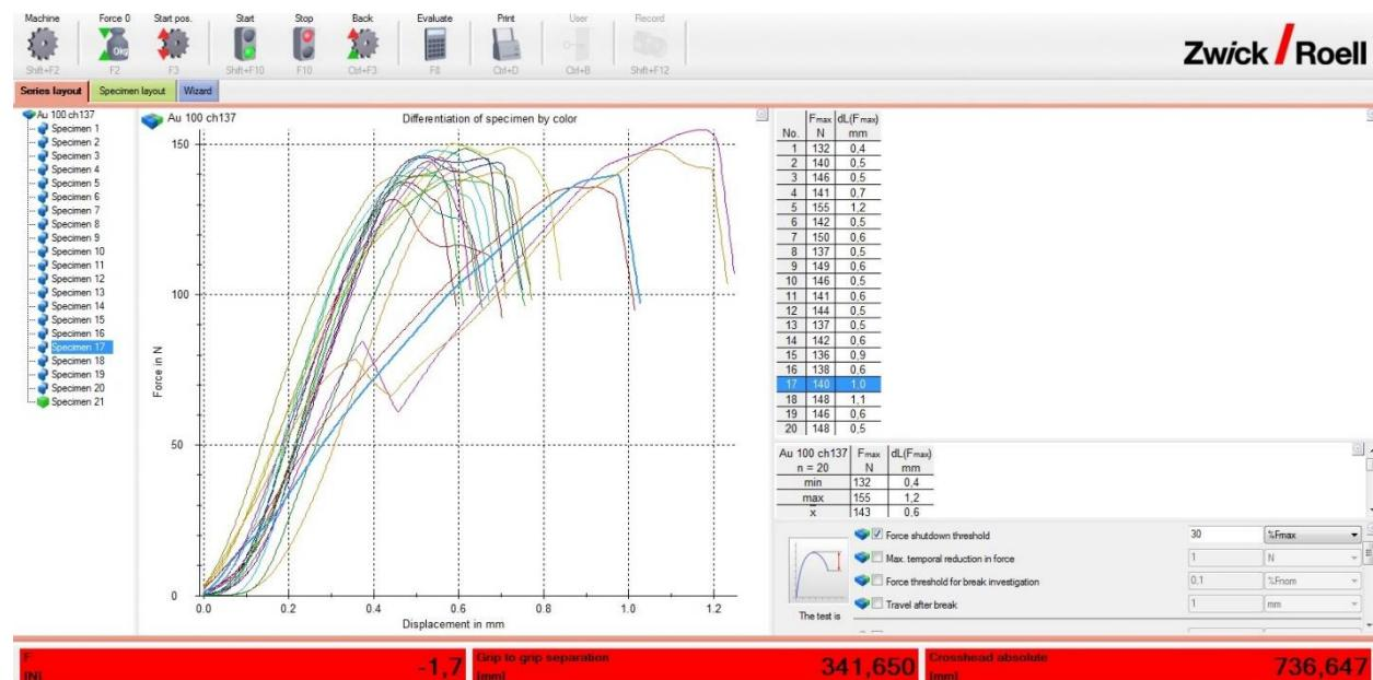
Dijagram sila-produljenje za 1,00 mm<sup>2</sup> žicu, 1,35 mm visina steznog spoja, prevlaka zlatna
