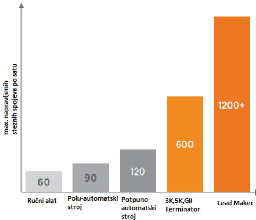
Slika 29. Maksimalna količina stezno spojenih terminala u jednom satu ovisno o alatu kojim se stezno spaja vodič [30]
