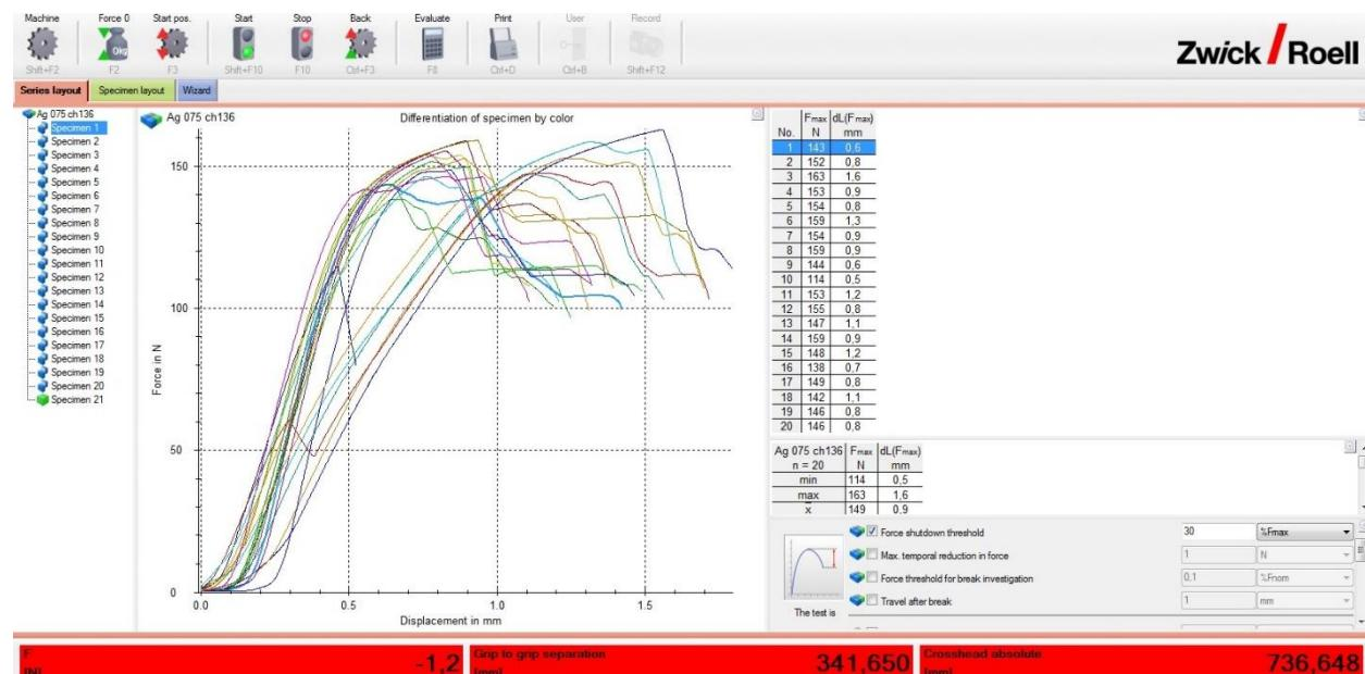
Dijagram sila-produljenje za  $0,75 \text{ mm}^2$  žicu, 1,35 mm visina steznog spoja, prevlaka srebra
