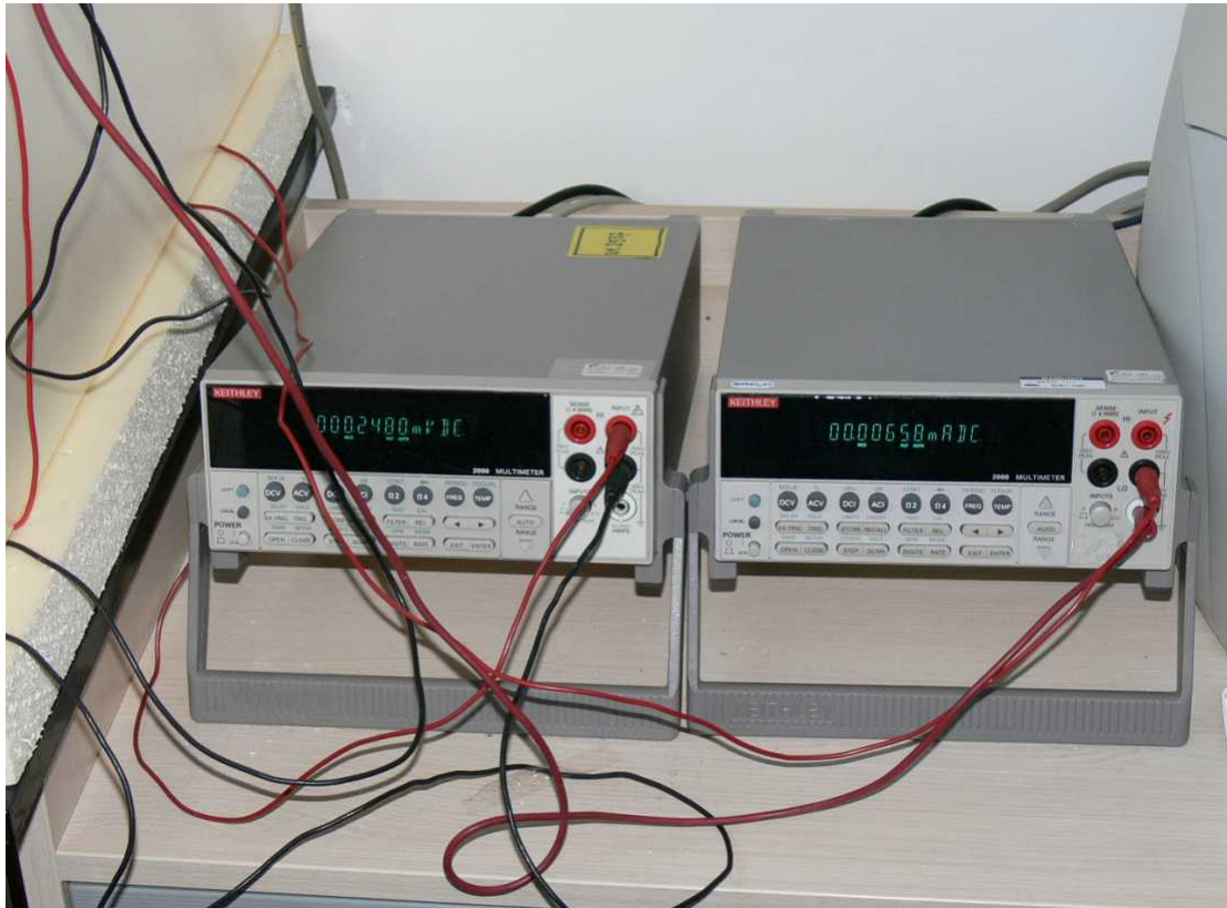
Slika 15: Voltmetar i ampermetar
