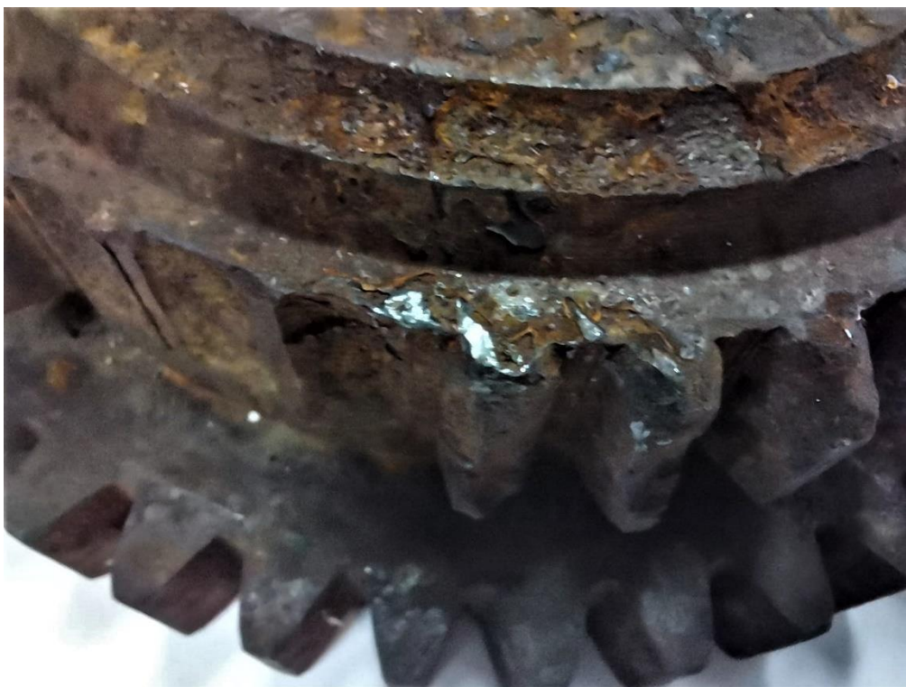
Slika 65. Prikaz korijena pukotine uslijed umora površine
