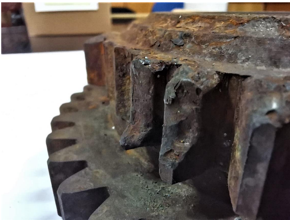
Slika 64. Površina loma zubi zupčanika
