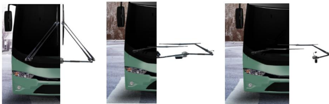
Slika 23. Pantografski sustav lijevo, panoramski sustav sredina, sustav sa dva motora desno [56]
