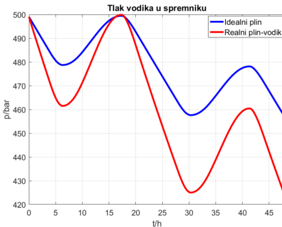
Slika 37. Tlak vodika u spremniku
