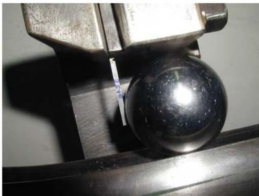
**Slika 35.** Zgagina metoda, položaj epruvete u napravi za stezanje.
