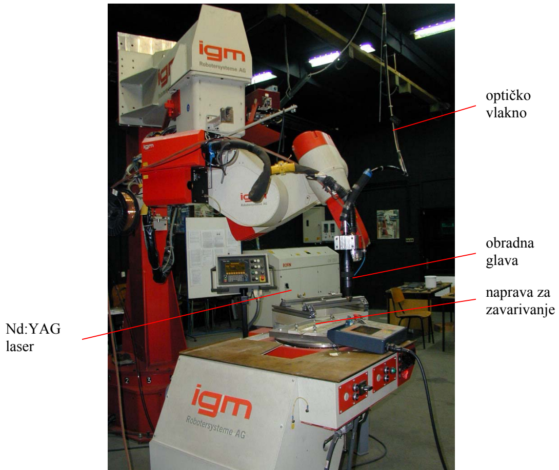
Slika 22. Sustav laser-robot, smješten u Laboratoriju za zavarivanje na FSB-u, Zagreb.
