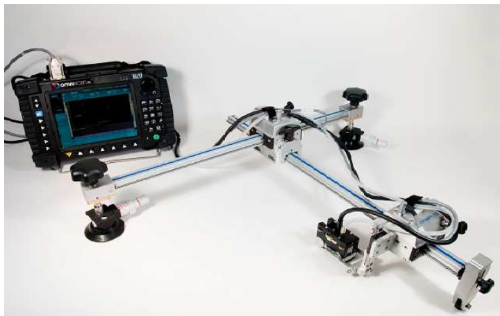
Slika 20: PA uređaj za ispitivanje kompozita [5]
