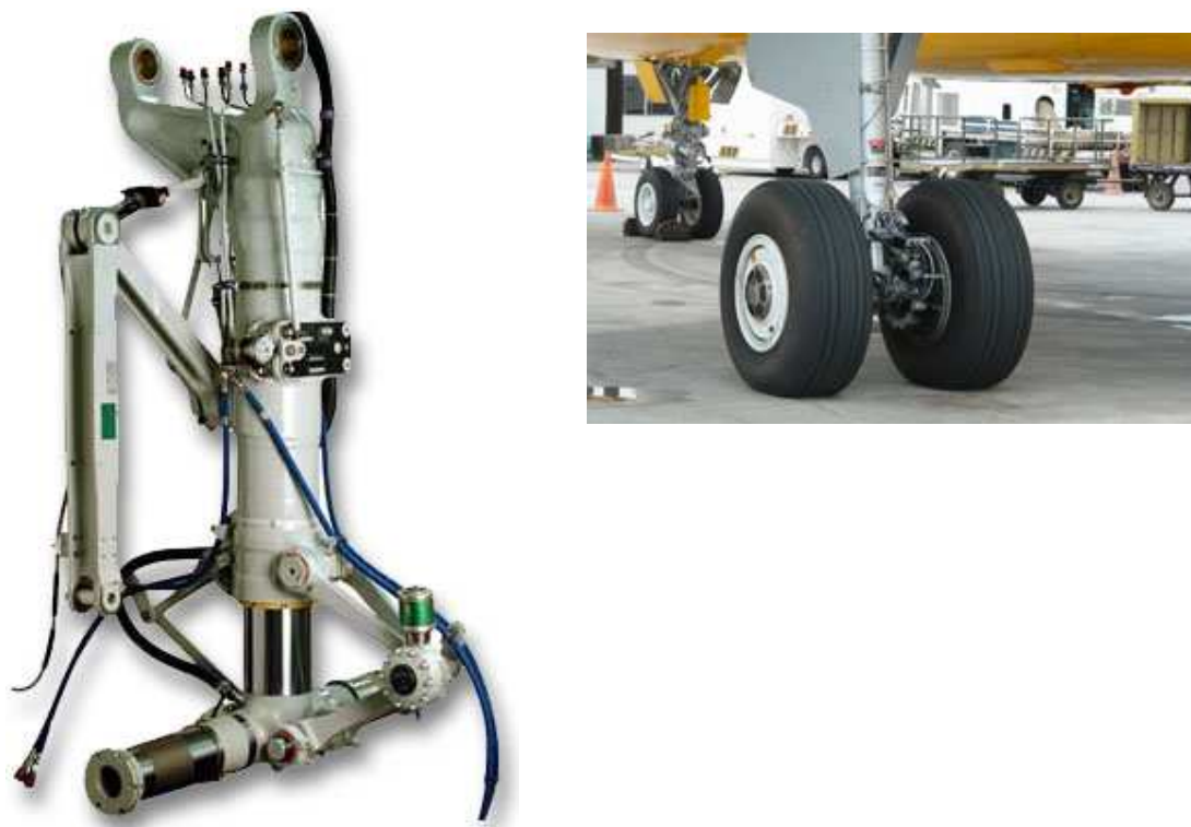
Slika 18: Cilindar stajnog trapa i stajni trap zrakoplova koji jedan je od primjera gdje se koristi višepretvornička ultrazvučna metoda ispitivanja [3]
