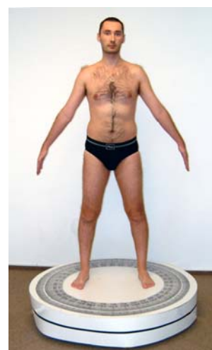
Sl. 79. BodySABA tjelesni statični skener
