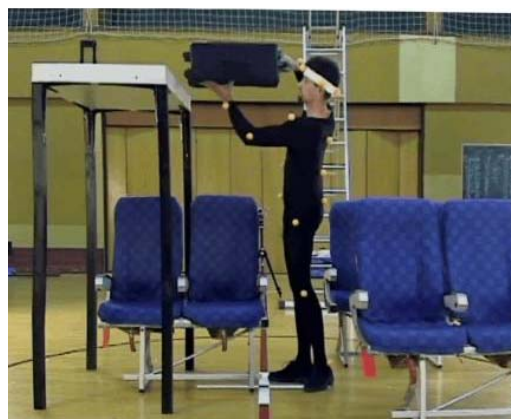
Sl. 89. Kinematogram slijeđenja ispitanika mocap sustavom VatoSABA 2.1.
