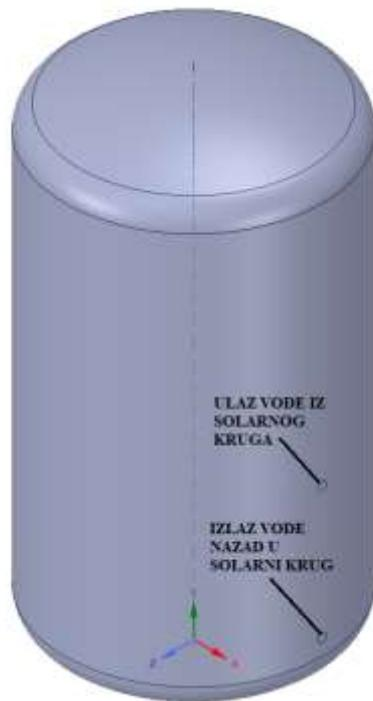
Slika 32 Geometrija spremnika (3D model)
