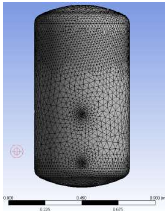
Slika 33 Korištena mreža za 3D model spremnika
