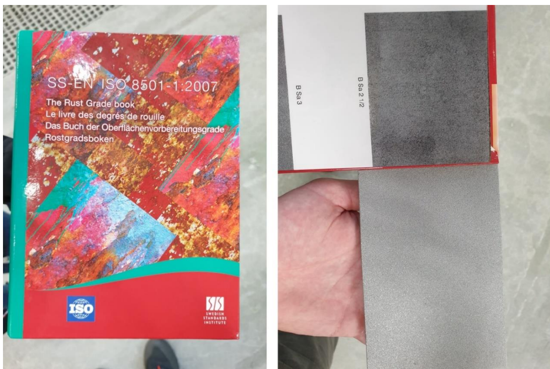
Slika 5.2. Određivanje razreda čistoće površine prema normi ISO 8501-1
