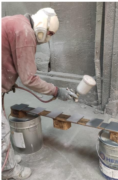
Slika 5.8. Nanošenje boje zračnim pištoljem
