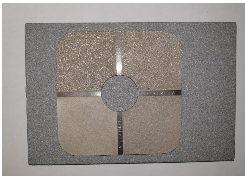
Slika 5.3. Određivanje hrapavosti komparatorom prema normi ISO 8503
