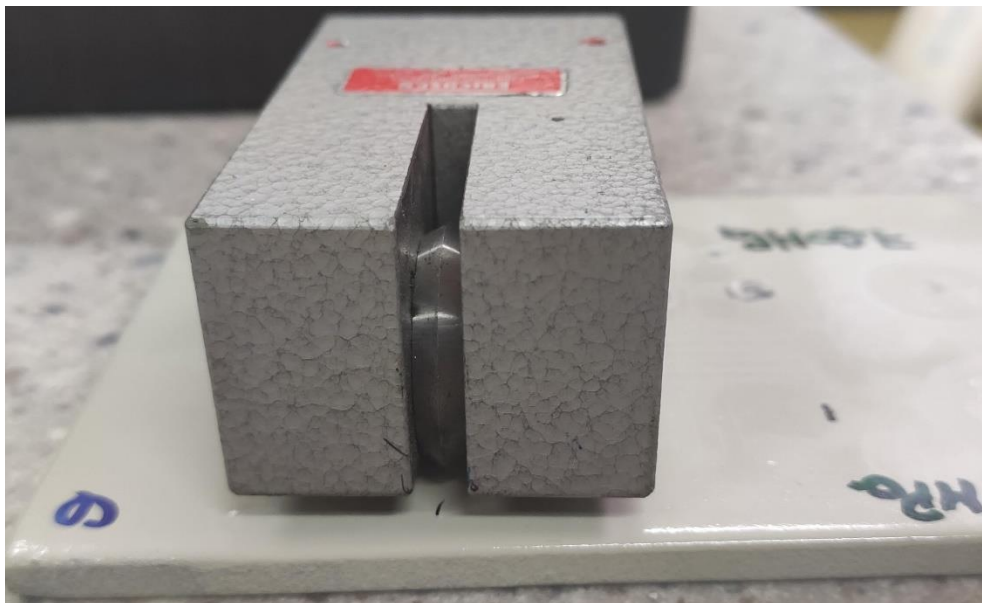
Slika 5.36. Postavljanje utega na uzorak
