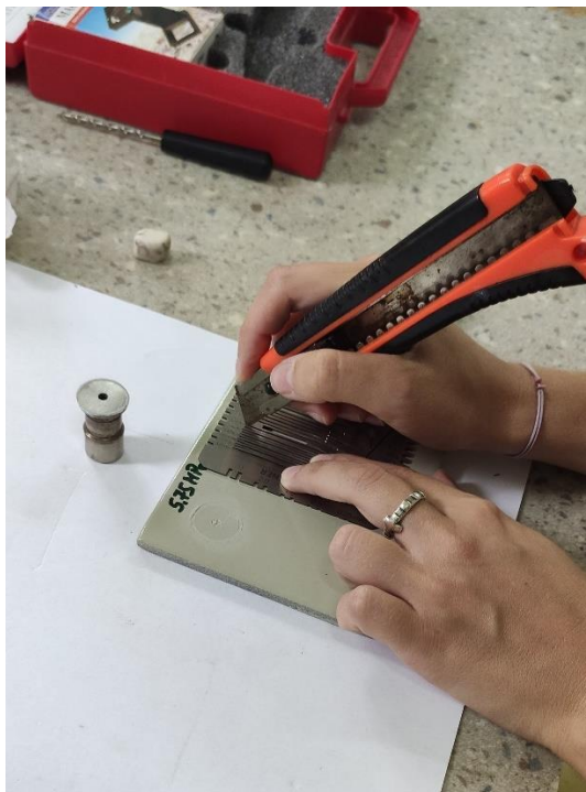
Slika 5.24. Izvođenje Cross cut testa
