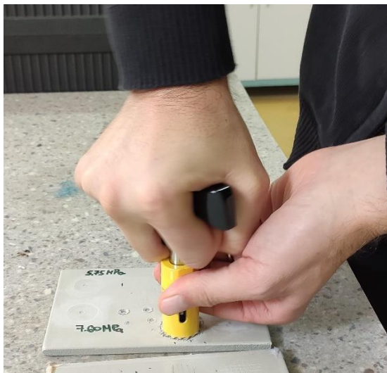
Slika 5.28. Rezanje premaza oko dolly -a prije Pull off testiranja
