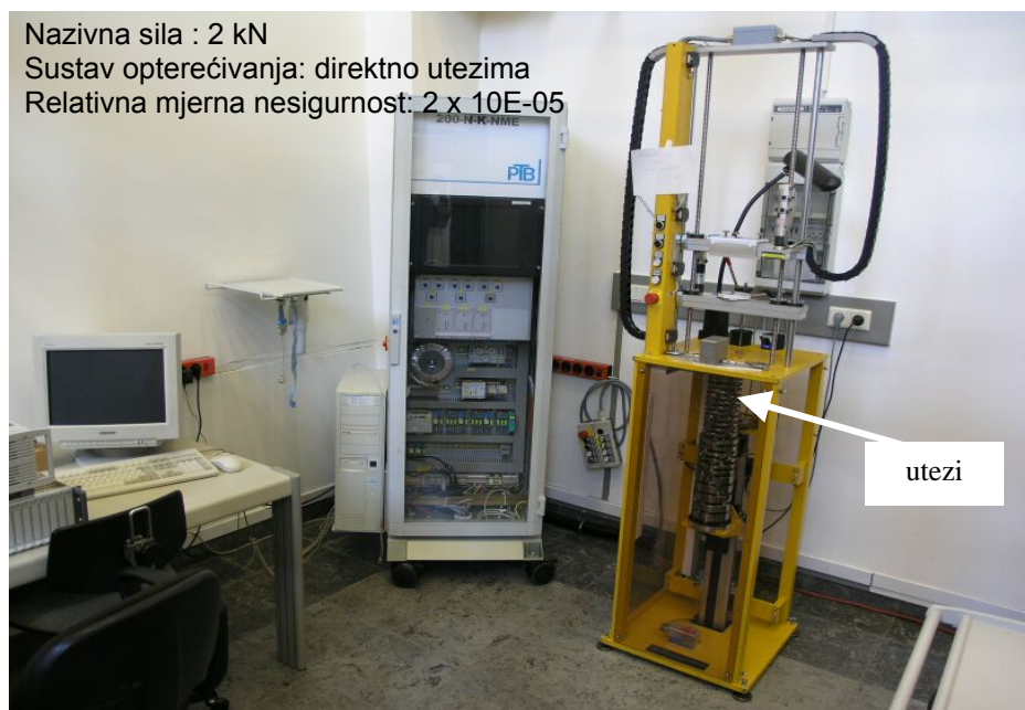
Slika 2.3: Nacionalni etalon sile Njemačke u PTB-u
