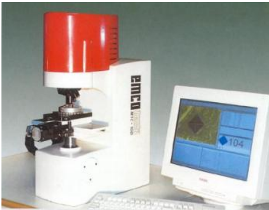
Slika 2.12: Tvrdomjeri u ispitnim mjeriteljskim laboratorijima a) pomoću deformacijskog tijela (Emco) b) pomoću utega (Zwick)
