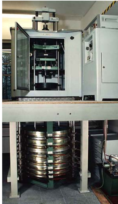
Slika 2.10: Primarni etalon tvrdoće u PTB-u [12]
