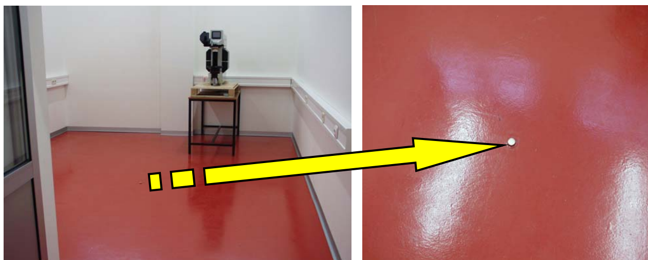
Slika 5.4: Točka gravimetrijskih i nivelmanskih mjerenja u LIMS-u
