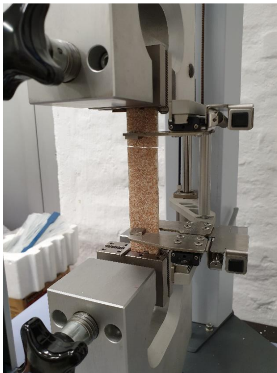
Slika 6.24. Ispitno tijelo J20-3 nakon ispitivanja na kidalici
