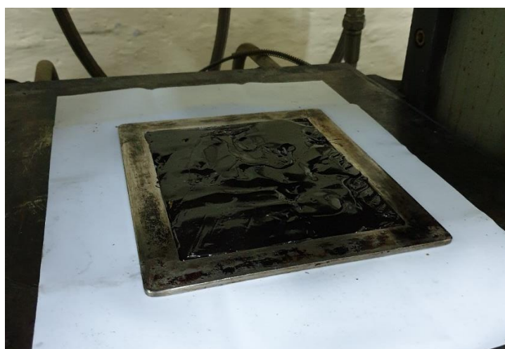
Slika 6.36. Smjesa u stvrdnutom stanju stavljena u kalup
