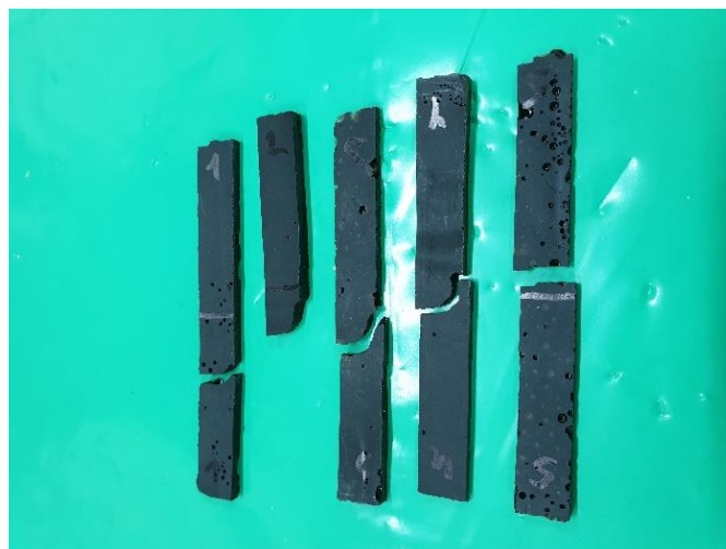
Slika 6.45. Ispitna tijela od PLA i 40 % ljuski lješnjaka nakon ispitivanja žilavosti
