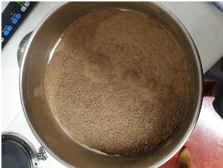
Slika 6.2. Prosijane ljuske lješnjaka, čestice veličine < 300 \mu\text{m}
