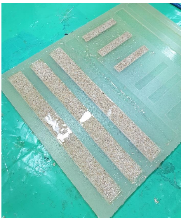
Slika 6.10. Kompozit epoksidne smole s 20 % ljuski jaja
