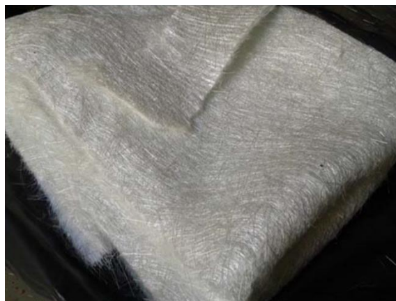
Slika 3.4. Stakleni predoblik (prošiveni mat) [12]
