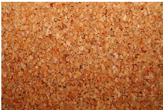
Slika 4.3. Usitnjeni pluteni materijal [24]
