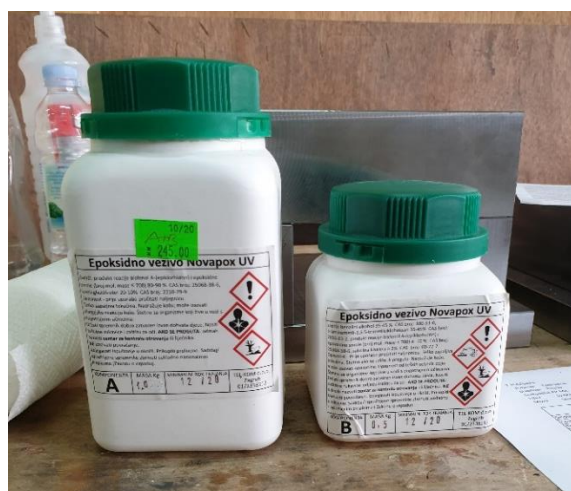
Slika 6.3. Smola i umreživalo korišteni za izradu kompozita
