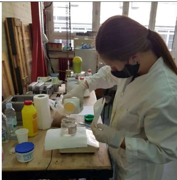
Slika 6.11. Priprema smole za izradu kompozita
