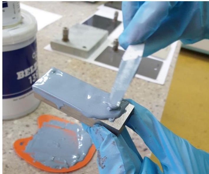
Slika 7.19. Nanošenje Belzona 1391T premaza na uzorak
