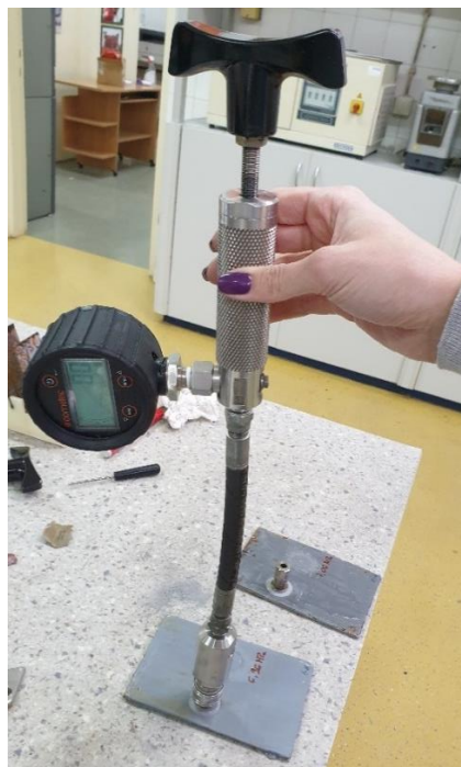
Slika 7.48 Ispitivanje prionjivosti premaza Pull – off metodom
