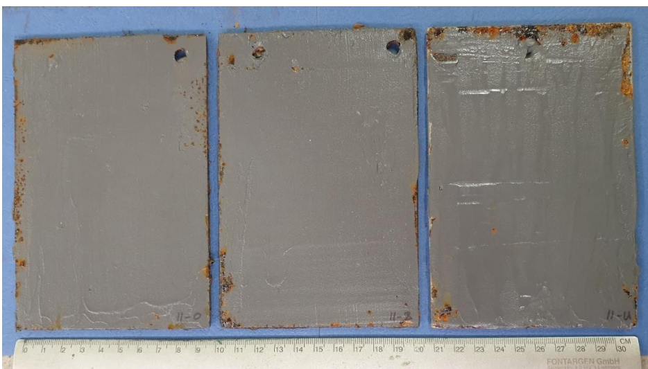
Slika 7.45. Prikaz premaza Belzona 1212 nakon 504 sata ispitivanja u vlažnoj komori
