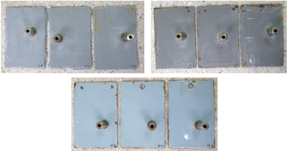
Slika 7.47. Uzorci pripremljeni za Pull – off ispitivanje
