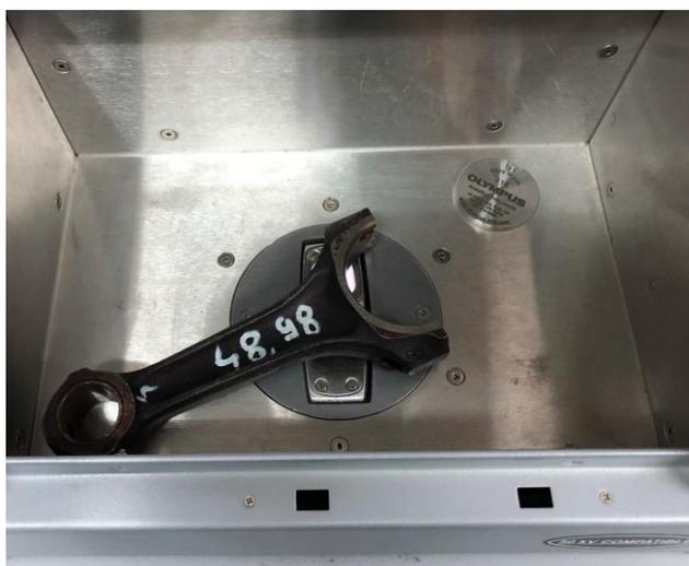
**Slika 16. Postupak snimanja klipnjače XRF analizatorom**
