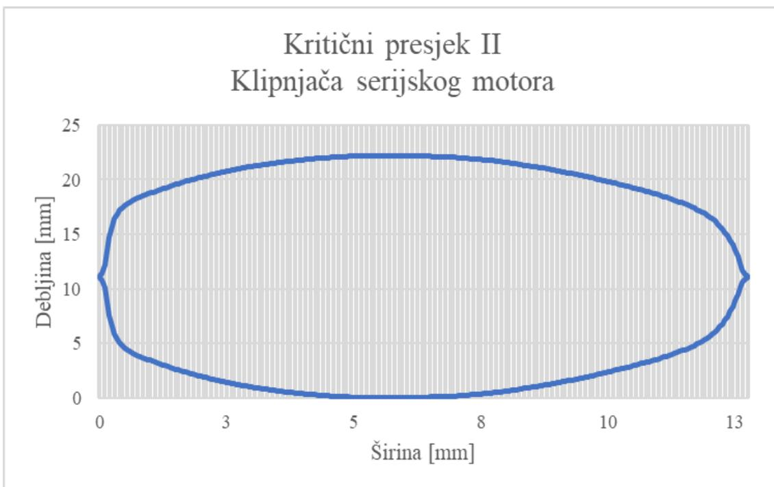
**Slika 33. Kritični presjek II klipnjače serijskog motora**
