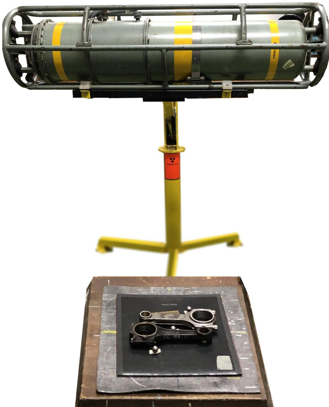
**Slika 17. Postupak prozračivanja RTG uređajem**
