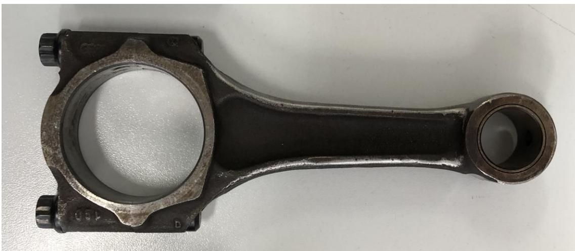
**Slika 14. Klipnjača serijskog motora s I-profilom**
