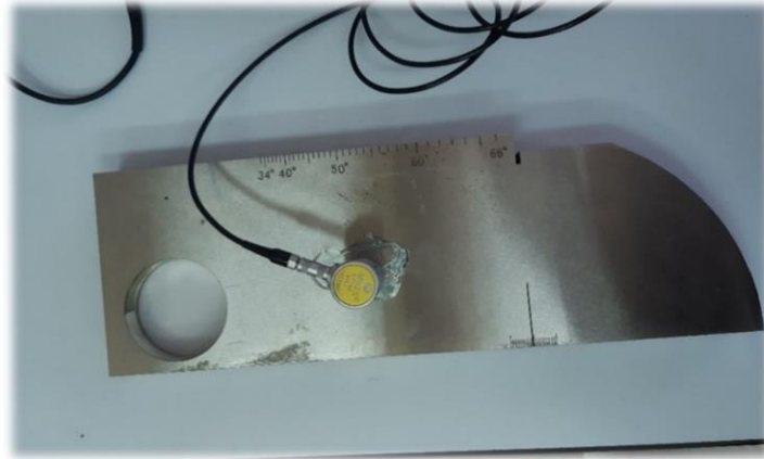
Slika 29. Mjerenje na etalonu V1
