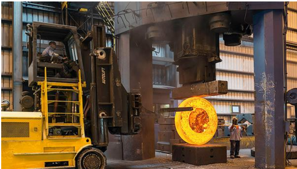
Slika 16. Postupak kovanja u toplom stanju [17]
