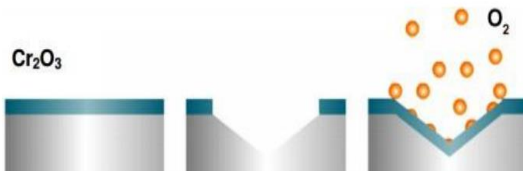
Slika 10. Prikaz procesa samoobnavljanja pasivnog sloja nehrđajućeg čelika [14]
