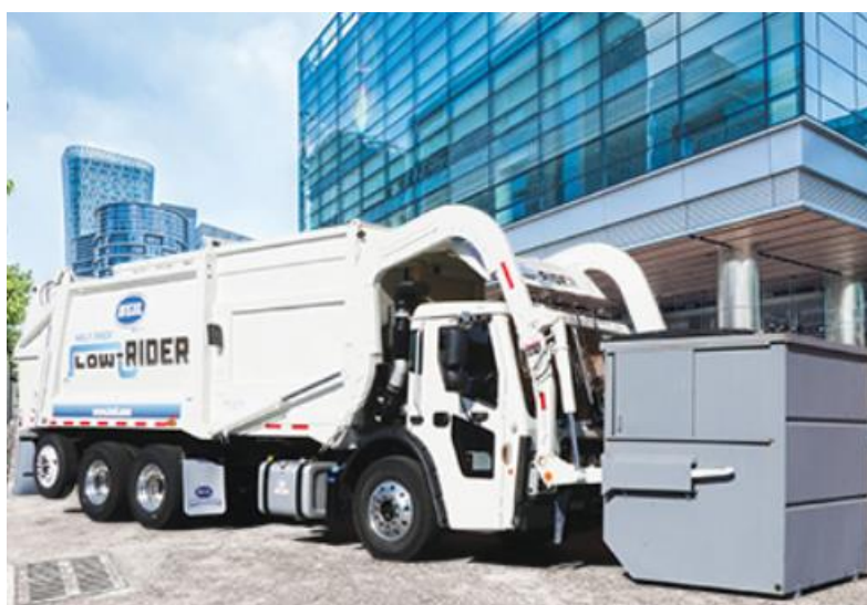
Slika 10. Heil Half/Pack LowRider kamion s prednjim utovarivanjem [13]
