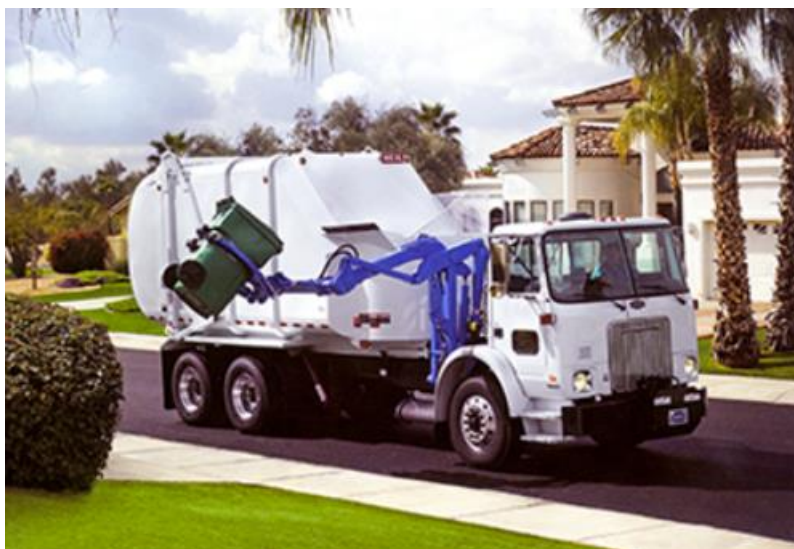
Slika 12. Heil kamion s bočnim utovarivanjem [13]
