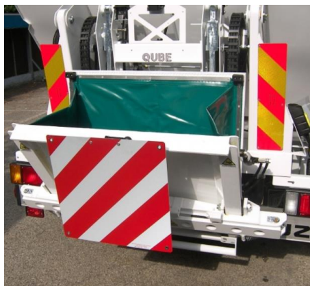
Slika 35. Džep za utovar vreća i sličnog otpada [36]
