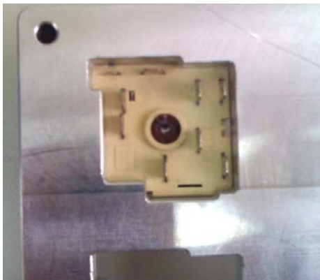
Slika 3.4 Donja strana spremnika proizvoda s regulatorom u gnijezdu
