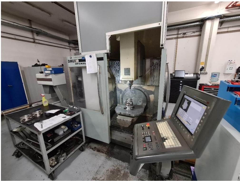
Slika 24. Cnc stroj DMU 50
