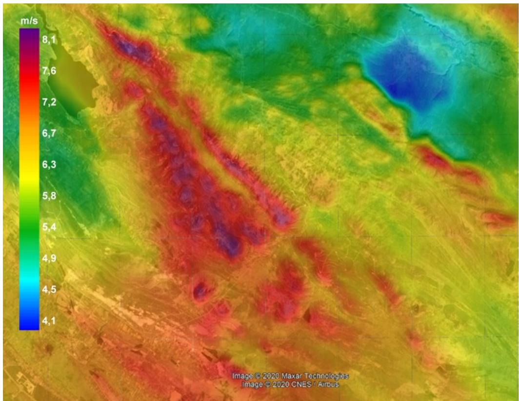
Slika 7.5: Računalna simulacija brzina vjetra (tlocrt) – Vortex [26]
