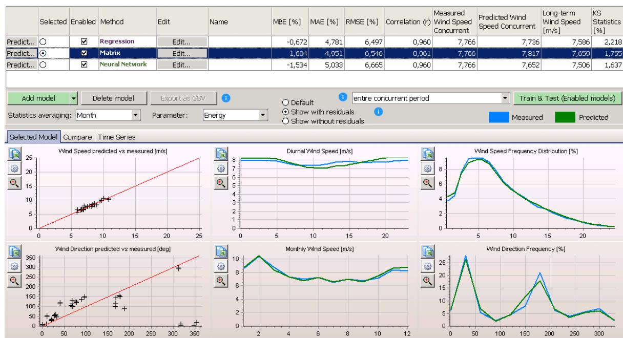
Slika 7.22: Predviđanje dugoročnih podataka MCP matričnim modelom [28]
