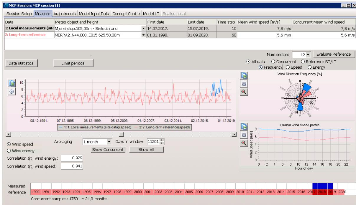
Slika 7.17: Unos mjernih podataka u MCP modul [28]
