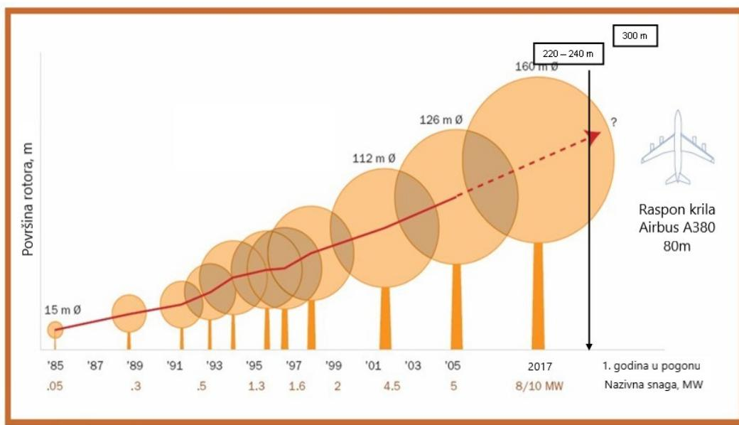
Slika 6.1: Prikaz povećanja rotora vjetroturbine tijekom godina [21]
