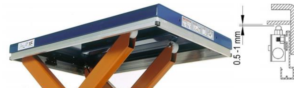
Slika 15. Sigurnosni okvir i način ugradnje mikroprekidača [2]
