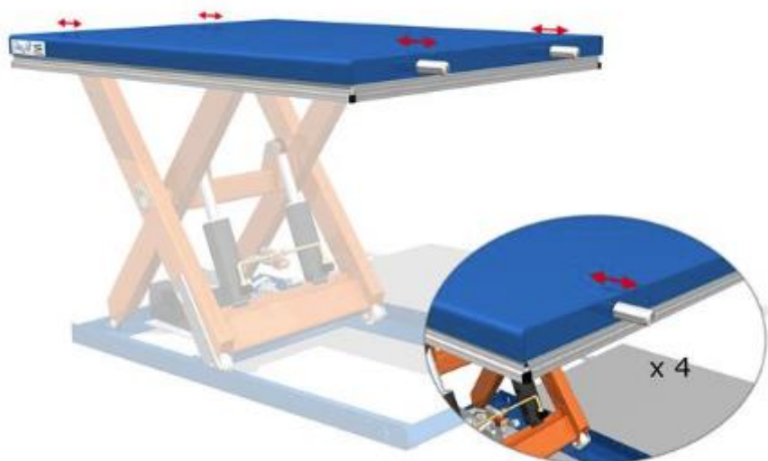
Slika 23. Zaključavanje platforme podizača [9]
