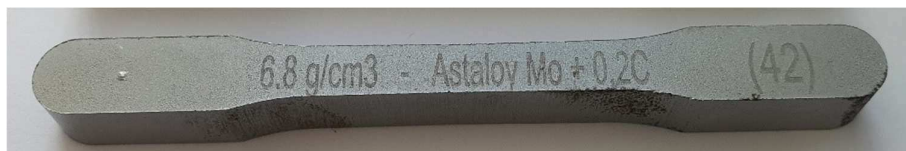
Slika 16. Uzorak epruvete Astaloy Mo+0,2C ( \rho = 6,8 \text{ g/cm}^3 )
