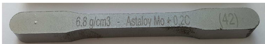
Slika 16. Uzorak epruvete Astaloy Mo+0,2C ( \rho = 6,8 \text{ g/cm}^3 )
