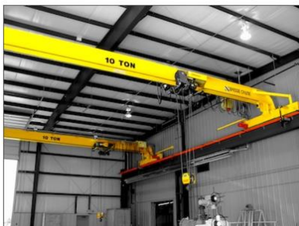
Slika 6. Bridge Crane mosni granici s ovješnim vitlom [3]
