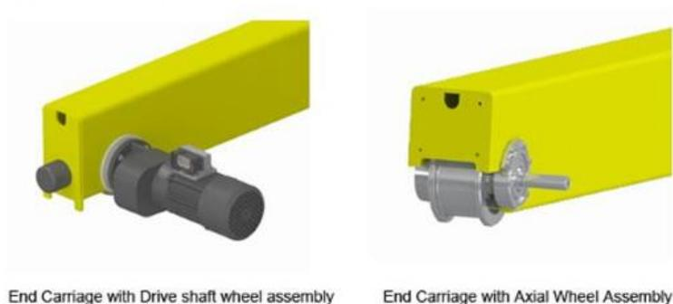
**Slika 11. Spojevi čeonog nosača i izbor kotača[9]**
