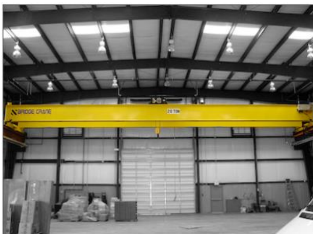
Slika 7. Bridge Crane mosni granik s dva mosta (I profil) [3]
