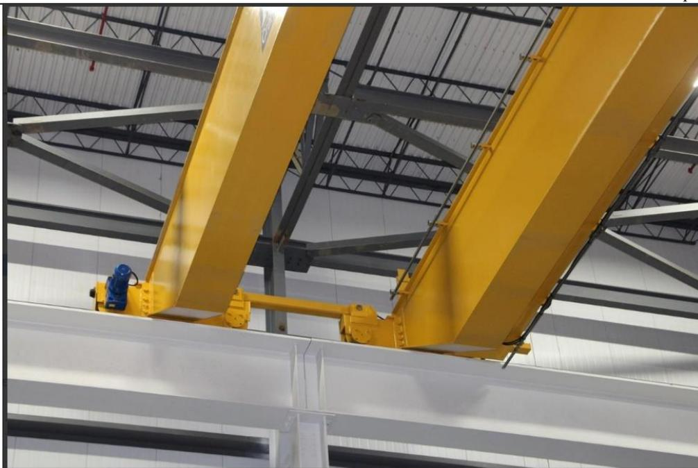
Slika 12. Most s većim brojem kotača [1]
