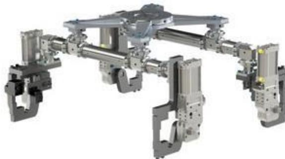
Slika 89. Robotska hvataljka sa pneumatskim stegama i pilotima [33]
