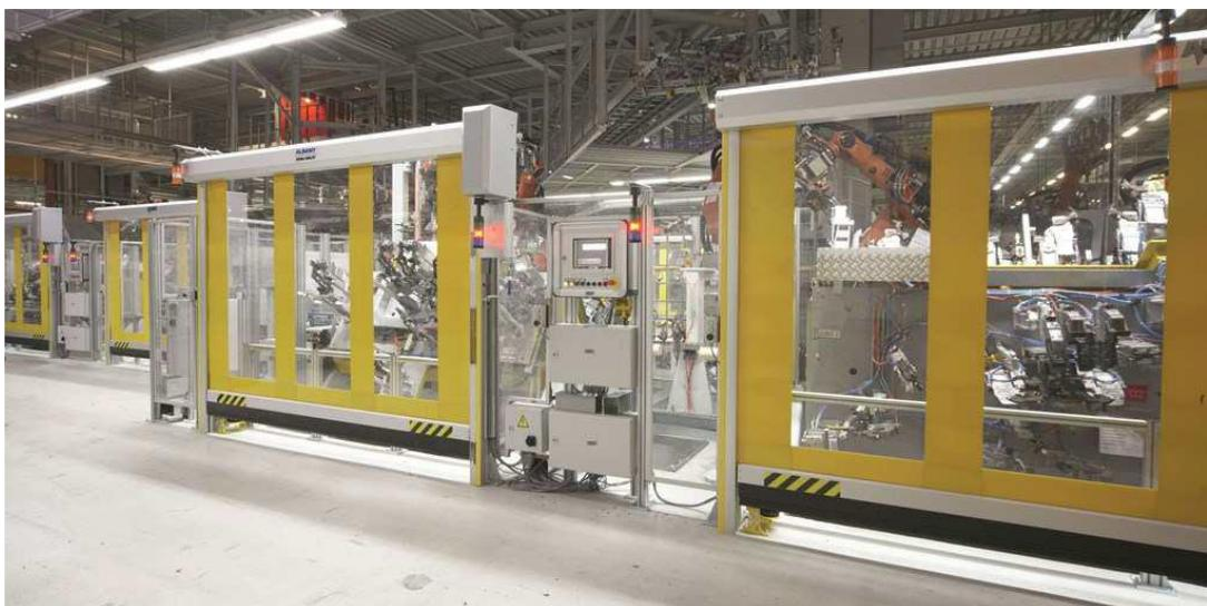
Slika 76. Mehaničke prepreke [17]
