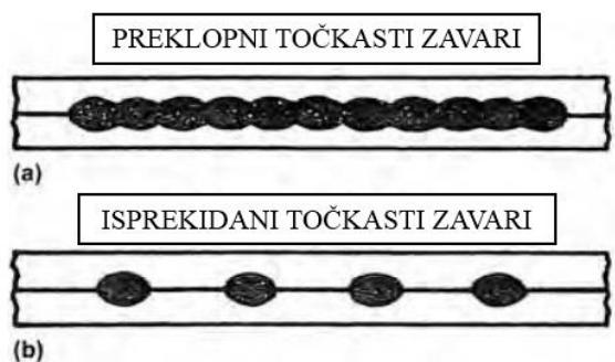
**Slika 14. Kontinuirani točkasti zavari. (a) Preklopni. (b) Isprekidani [7]**
