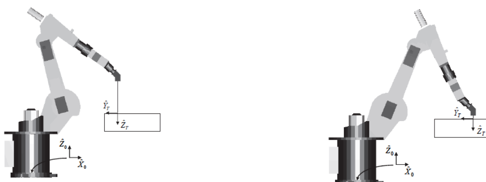
Slika 96. Prikaz koordinatnih sustava robota za MAG zavarivanje
