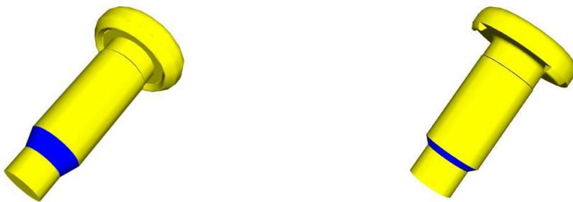
Slika 11. Vijci za elektrootporno bradavičasto zavarivanje [11]
