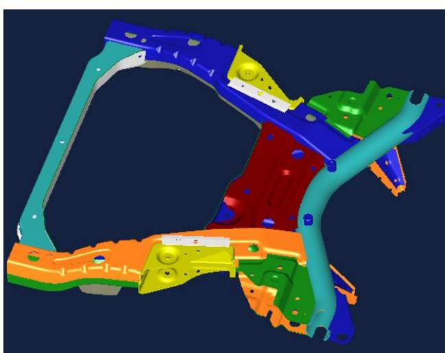
Slika 122. Prikaz nosača motora (eng. *suspension crossmember*)
