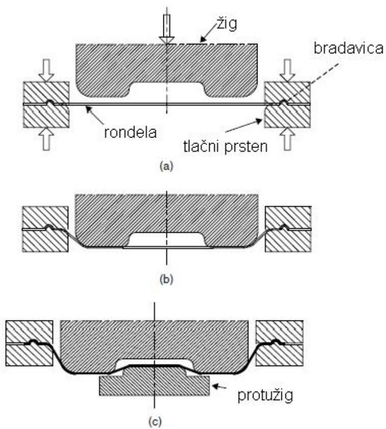
Slika 1: Presjek matrice za plitko vučenje [2]
