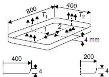
Slika 13: Shema pravokutno plitko vučene panele [2]
