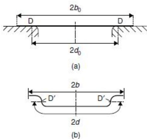
Slika 11: Presjek plitkog vučenja ilustirajući omjere vučenja i rastezanja [2]
