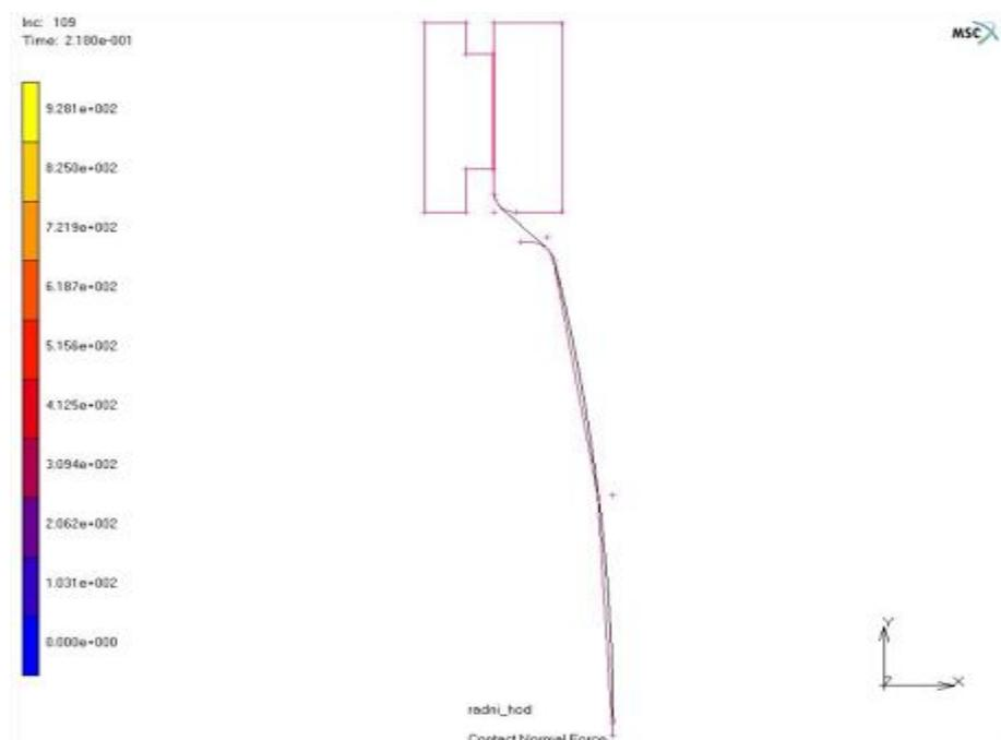
Slika 19: 2D model deformiran na zadalu dubinu od  $0.7 h_{max}$
