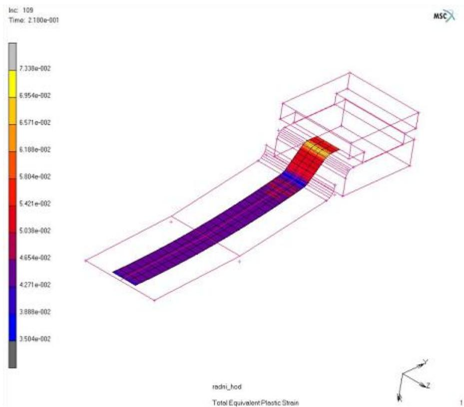
Slika 21: 3D model deformiran na zadalu dubinu od  $0.7 h_{max}$
