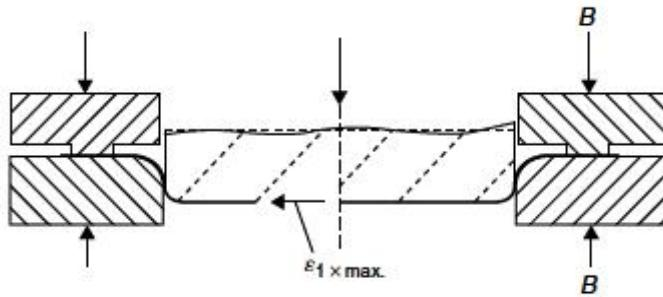
Slika 14: Presjek vučne matrice sa vertikalnim bočnim zidovima
