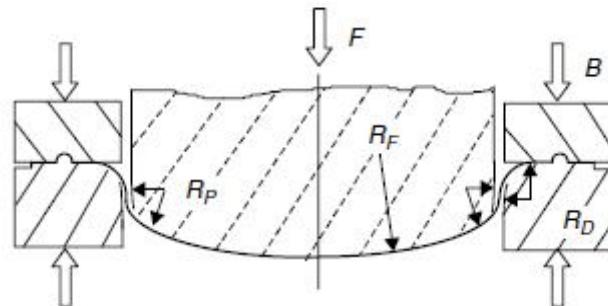
Slika 2: Jednostavna matrica za plitko vučenje sa žigom koji ima kružni izgled
