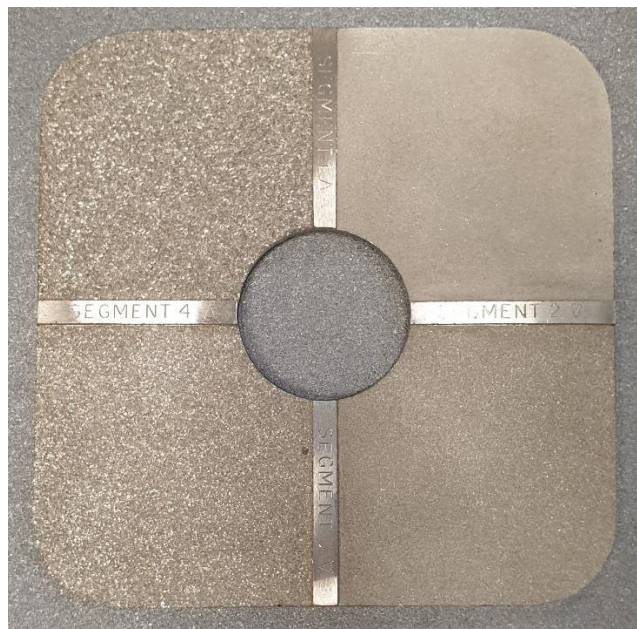
Slika 31. Usporedba pripremljene površine s komparatorom hrapavosti prema HRN EN ISO 8503-1:2012
