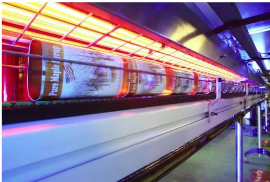
Slika 22. Otvrdnjavanje boje na posudama IC ugljičnim lampama [22]
