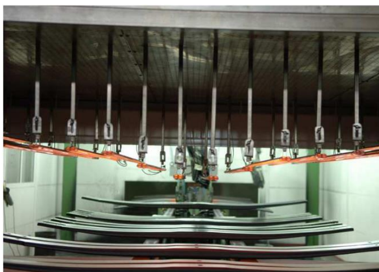
Slika 23. IC kabina za sušenje lisnatih zavojskih opruga [23]
