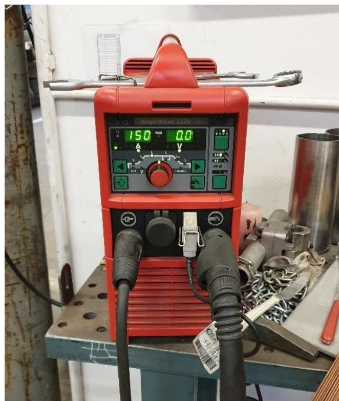
Slika 21. Izvor struje za zavarivanje *MagicWave 2200*
