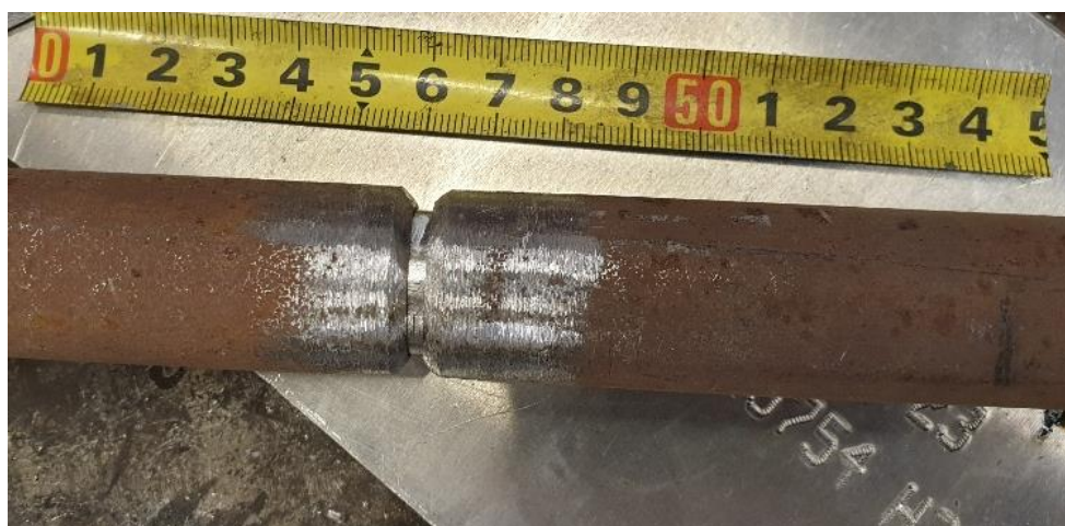
Slika 26. Pripremljene cijevi za zavarivanje čeonog spoja
