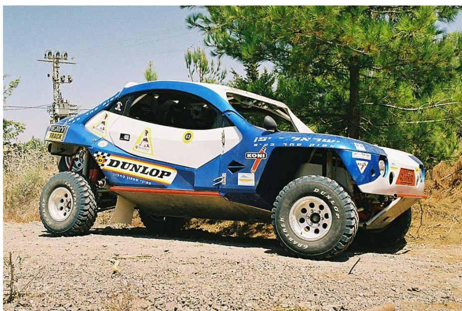
Slika 8. Trkači *buggy* s V8 motorom i kućištem od stakloplastike [10]
