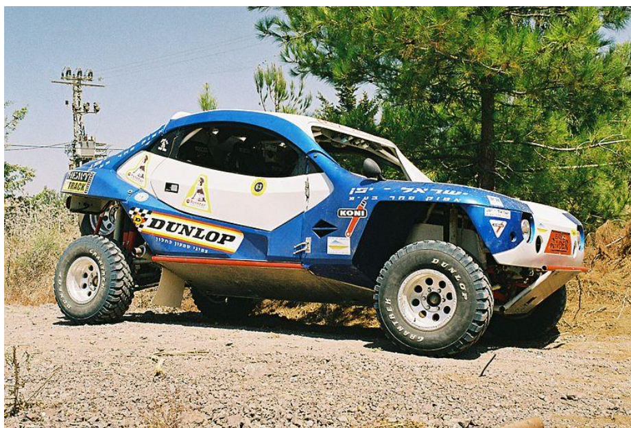
Slika 8. Trkaći buggy s V8 motorom i kućištem od stakloplastike [10]
