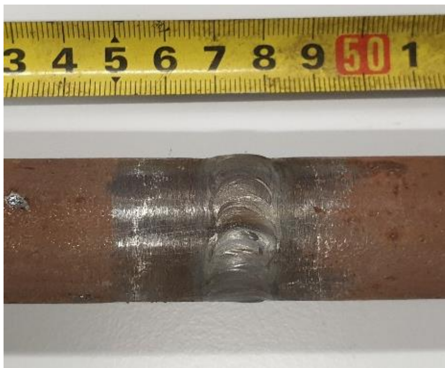
Slika 28. Zavareni sučeljeni spoj
