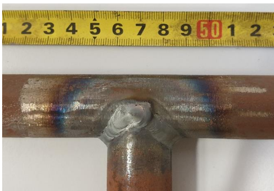
Slika 27. Zavareni kutni spoj
