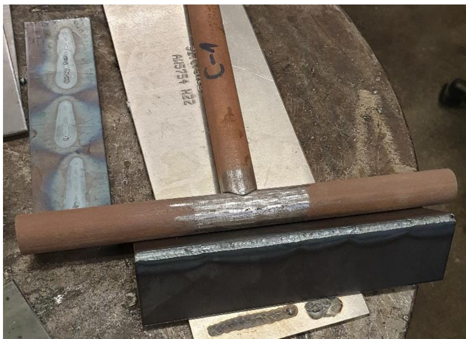
Slika 25. Pripremljene cijevi za zavarivanje kutnog spoja
