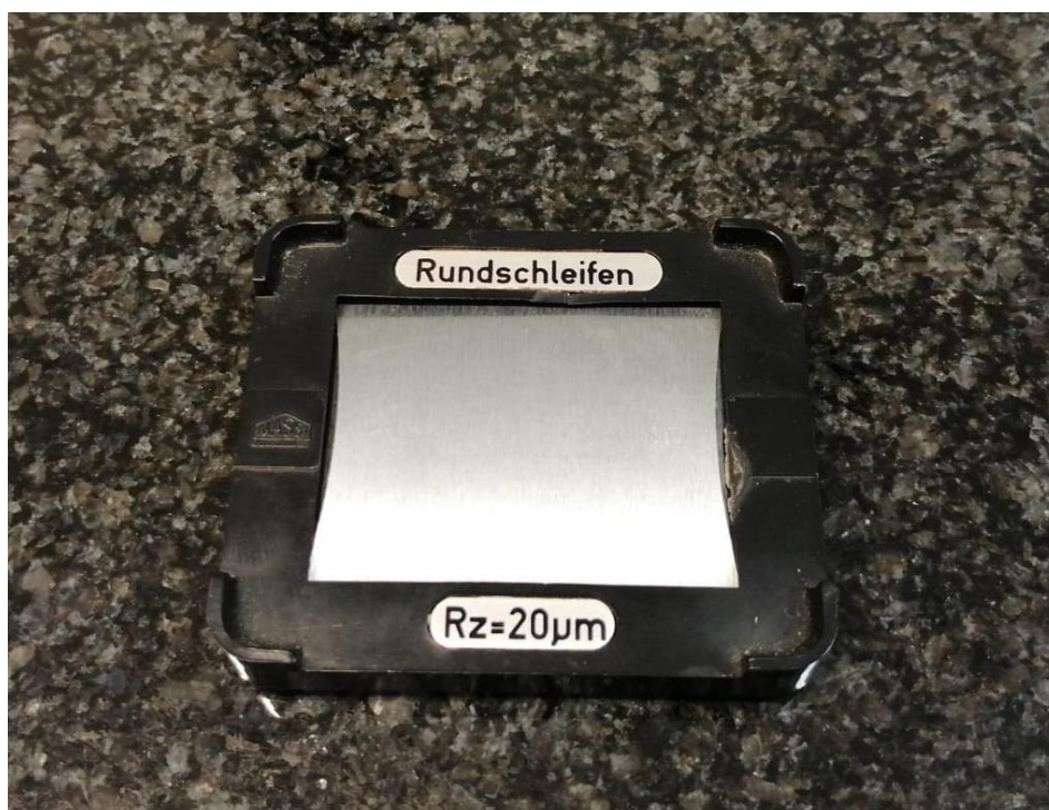
Slika 22. Etalon s iregularnom geometrijom
