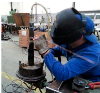
Slika 25. Zavarivanje cijevi od čelika P91 [12]
