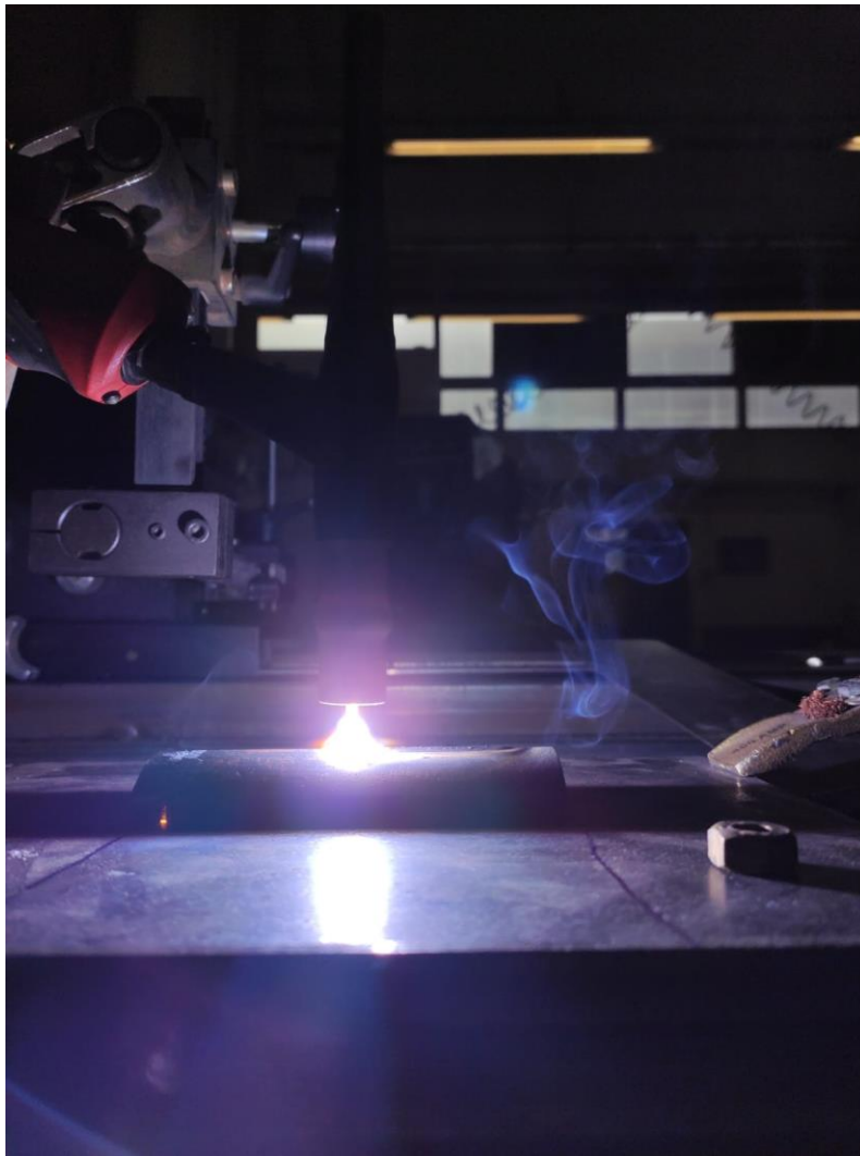
Slika 44. Postupak protaljivanja uzorka od čelika P91 pod zaštitom 85 % Ar / 15 % He
